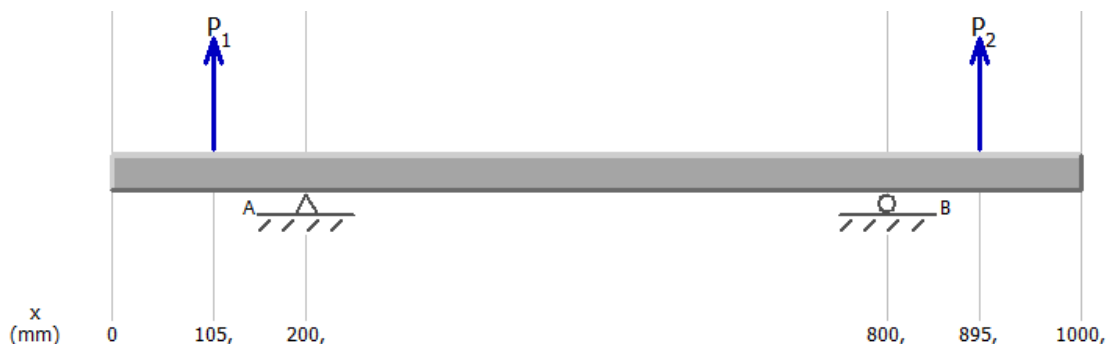
Slika 32. Opterećenje gornjeg vratila u vertikalnoj ravni
