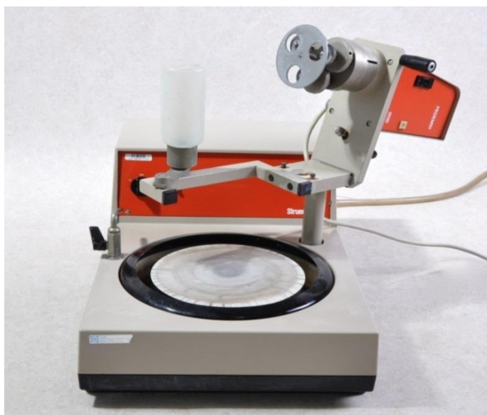
Slika 27: Uređaj za brušenje i poliranje (Struers DAP-V)
