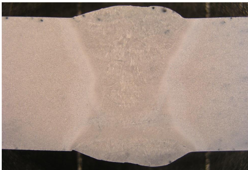
Slika 41: Makro nagriženi uzorak zavarenog spoja (2)
