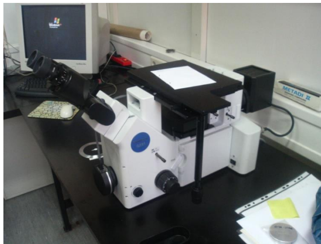
Slika 1: Svjetlosni mikroskop OLYMPUS GX51
