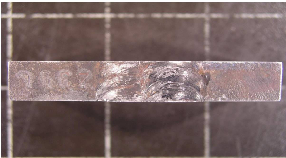
Slika 26: Prikaz poprečnog presjeka ispitnog uzorka, t=30\text{mm}
