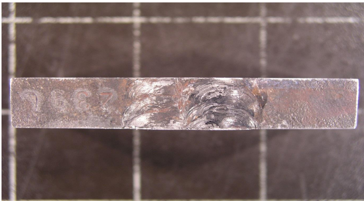
Slika 26: Prikaz poprečnog presjeka ispitnog uzorka, t=30\text{mm}
