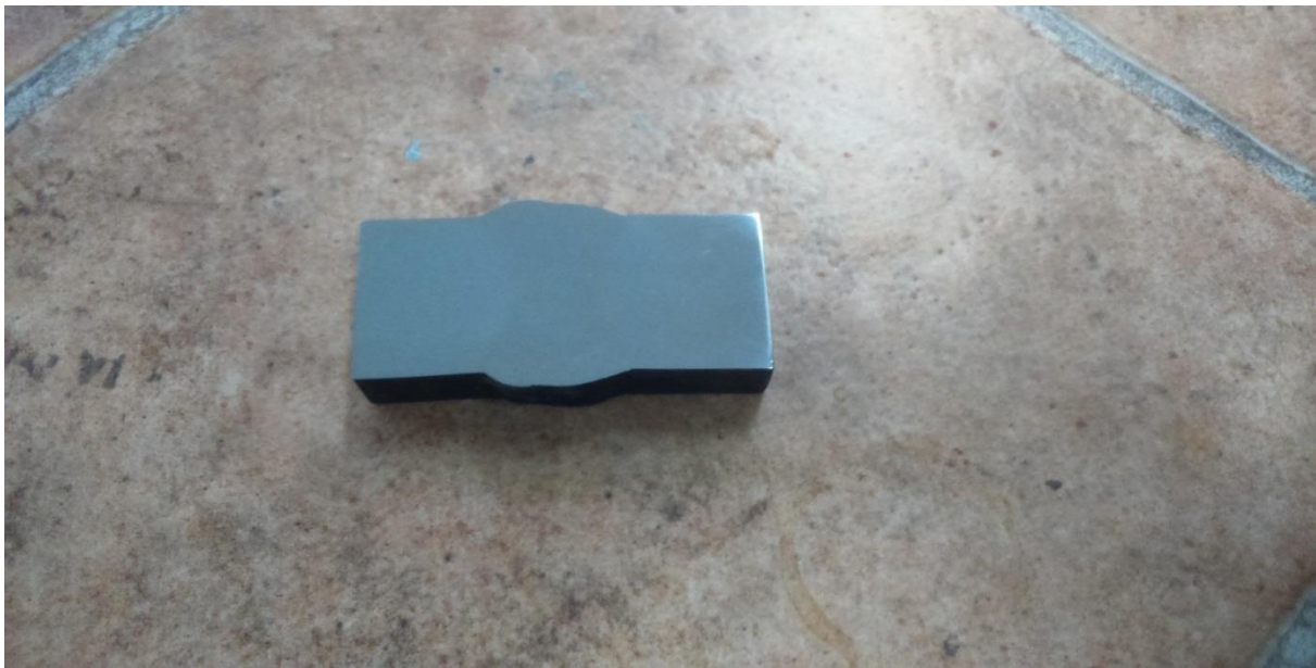
Slika 25: Ispitni uzorak čelika X3CrNiMo 13-4
