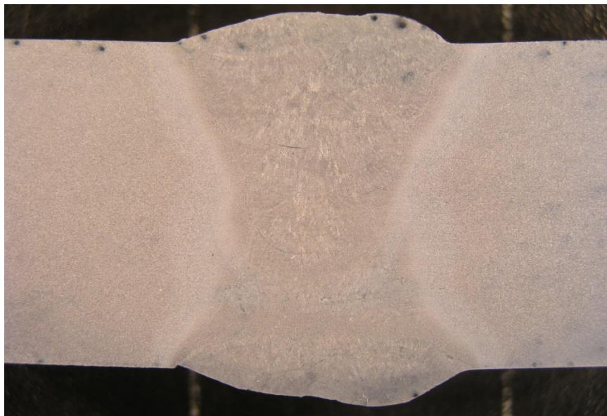
Slika 41: Makro nagriženi uzorak zavarenog spoja (2)
