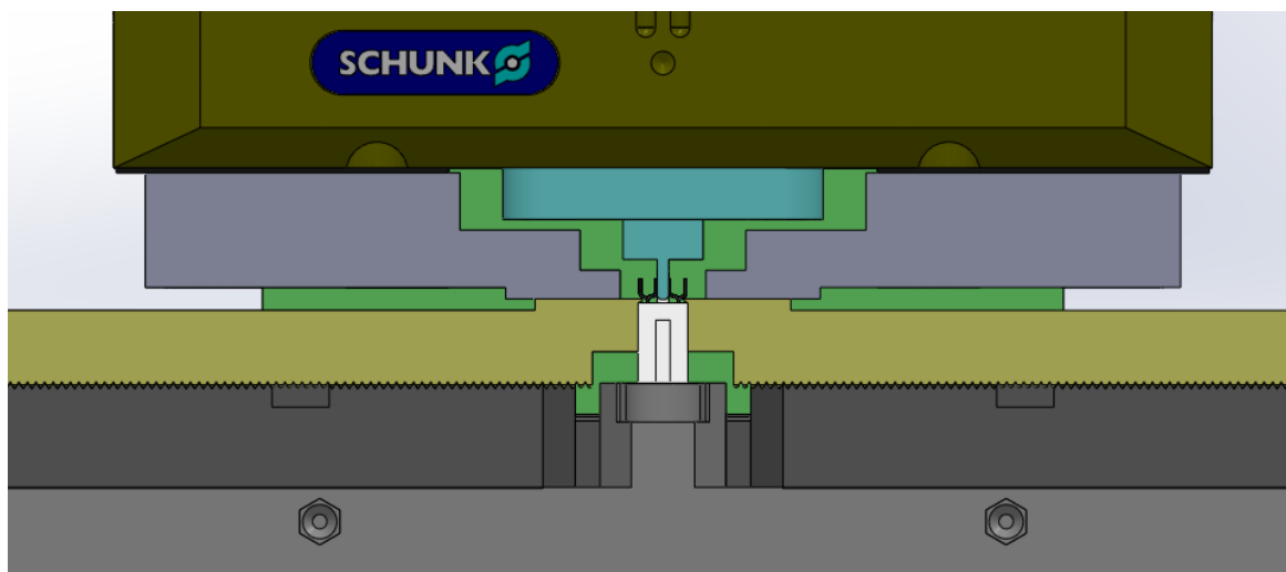
Slika 44. Priključak PCI s iglicama prije odvajanja
