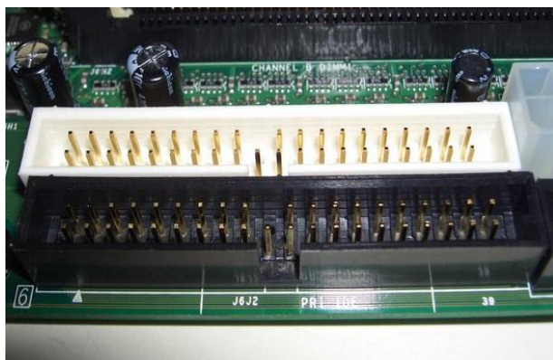
Slika 7. IDE priključak spojen na matičnu ploču i nakon odvajanja s matične
