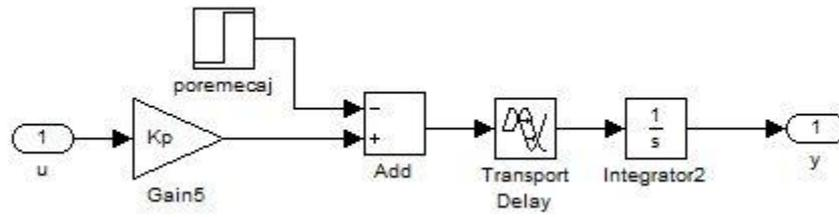
*Simulink model procesa sa izraženim mrtvim vremenom i integracijskim djelovanjem*
