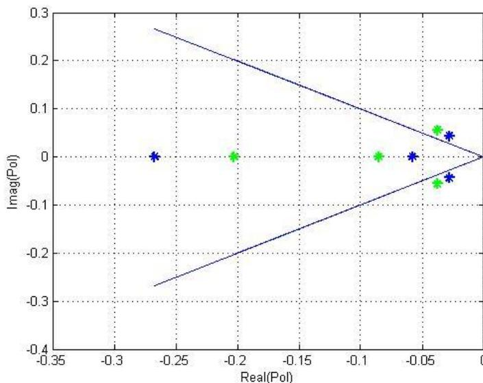
Slika 13. Polovi sustava PI i PID regulatora podešeni uz primjenu aproksimacije mrtvog vremena aperiodskim članom drugog reda
