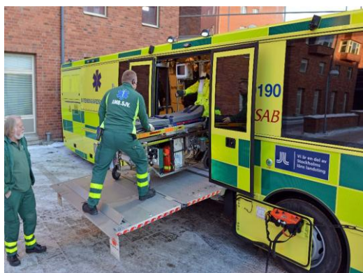
Slika 2.7. Rampa ICU vozila
