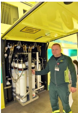
Slika 2.9. Odjeljak sa spremnicima kisika
