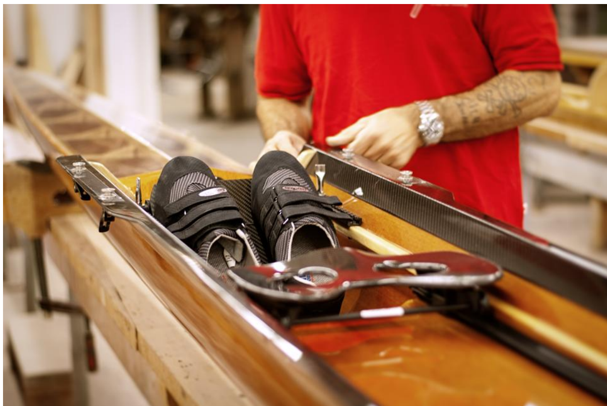
Slika 31. Unutrašnjost Stämpflijevog drvenog čamca mase 14 kg [9]
