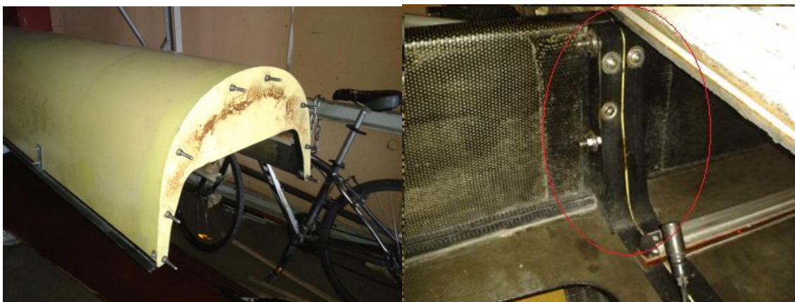
Slika 9. Izvedba čamca u segmentima: zasebni segment (lijevo) i unutrašnjost čamca na spoju dva segmenta (desno)
