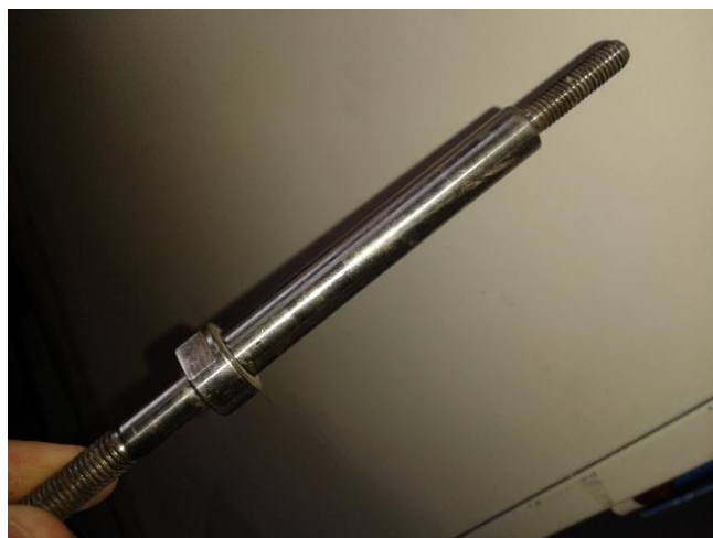
Slika 22. Osovina od ušice od nehrđajućeg čelika
