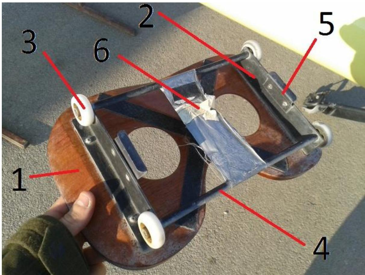
Slika 19. Drveno pomicno sjedalo; 1-gornji dio sjedala; 2-nosač od aluminijskog lima; 3-kotačić; 4-aluminijска цјев с navojем; 5-aluminijski lim koji sprječava da sjedalo ispadne iz čamca kada se čamac okreće naopako; 6-magnet za mjerjenje frekvencije zaveslaja
