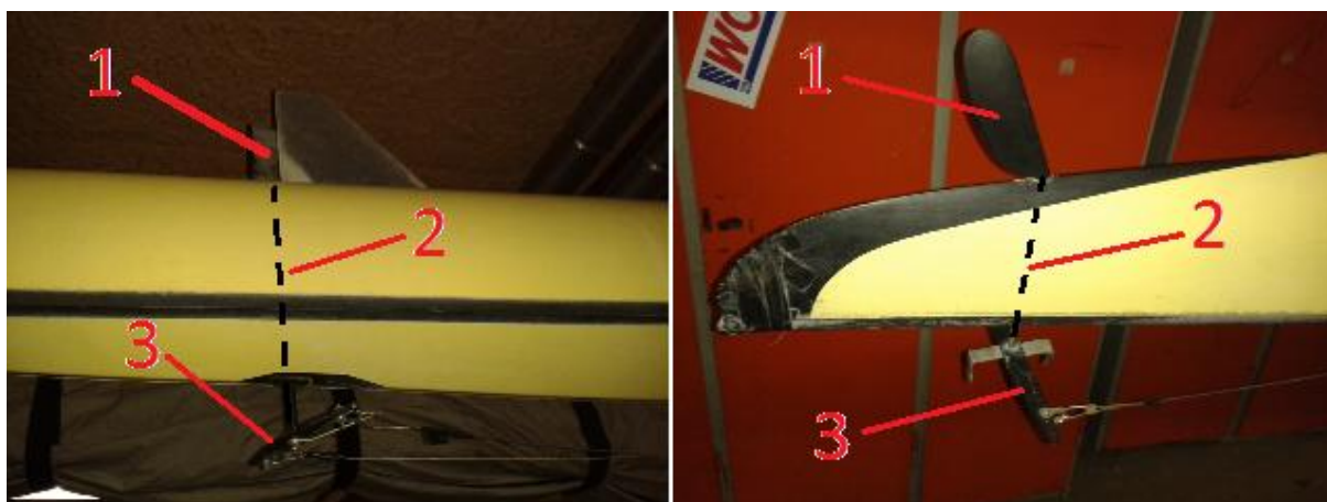
Slika 27. Kormilo spojeno na peraju (lijevo) i kormilo odvojeno od peraje (desno); 1- list kormila; 2- linija vratila kormila; 3- poluga kormila
