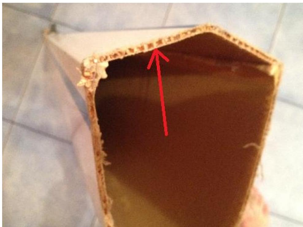
Slika 7. Presjek pramca od aramidne sendvič-konstrukcije
