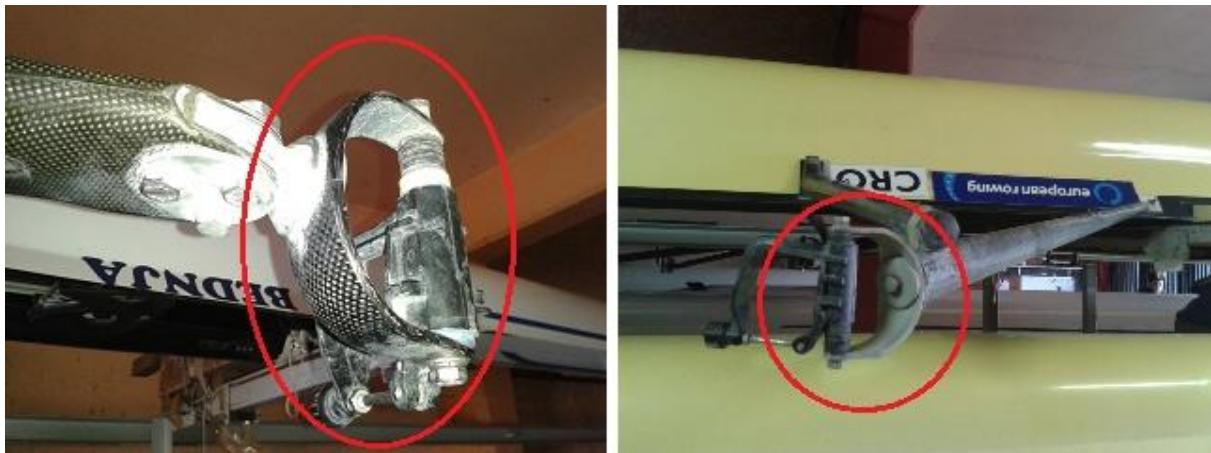
**Slika 17. Čeljusti za prihvrat ušice ojačane ugljičnim vlaknima (lijevo) i od aluminija (desno)**
