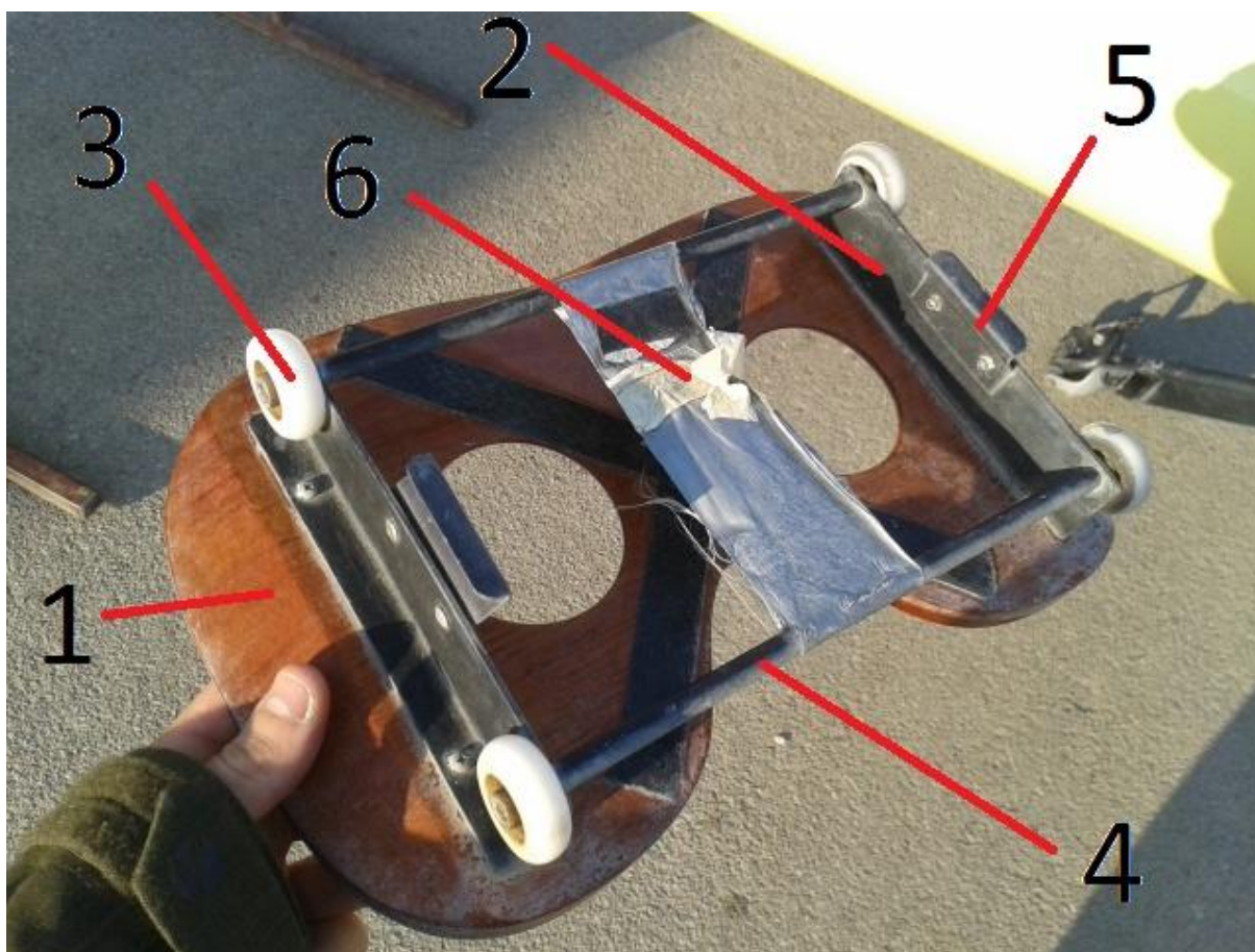
Slika 19. Drveno pomično sjedalo; 1-gornji dio sjedala; 2-nosač od aluminijevog lima; 3-kotačić; 4-aluminijska cijev s navojem; 5-aluminijski lim koji sprječava da sjedalo ispadne iz čamca kada se čamac okrene naopako; 6-magnet za mjerenje frekvencije zaveslaja
