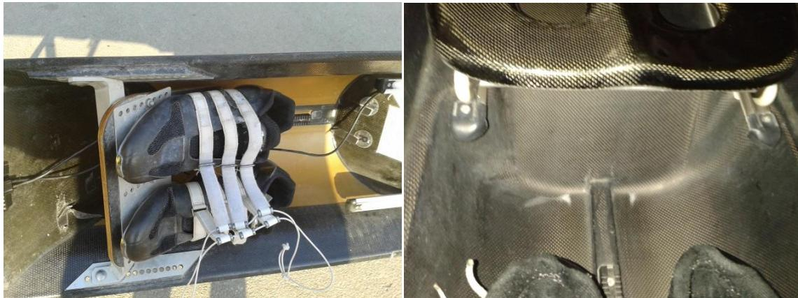
**Slika 8. Unutrašnjost čamca s aramidnom osnovom (lijevo) i s ugljičnom osnovom (desno)**
