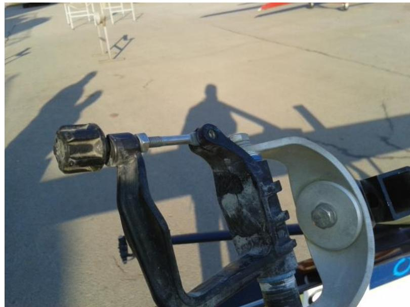
**Slika 10. Ušica s osiguranjem od ispadanja vesla od nehrđajućeg čelika**
