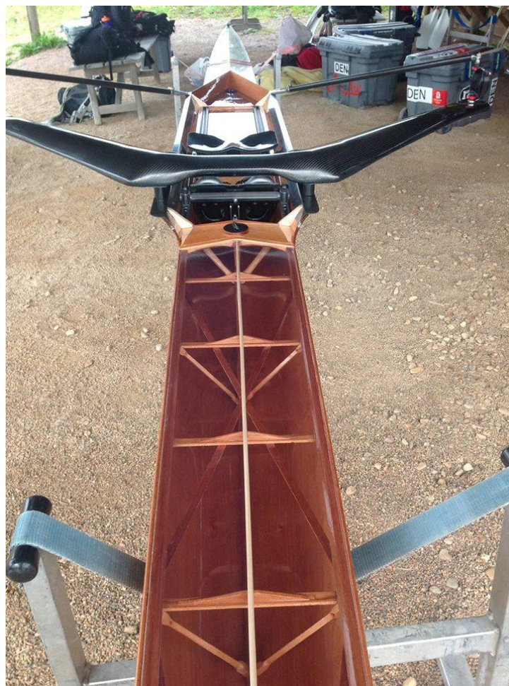
Slika30. Stämpflijev drveni samac mase 14 kg [9]
