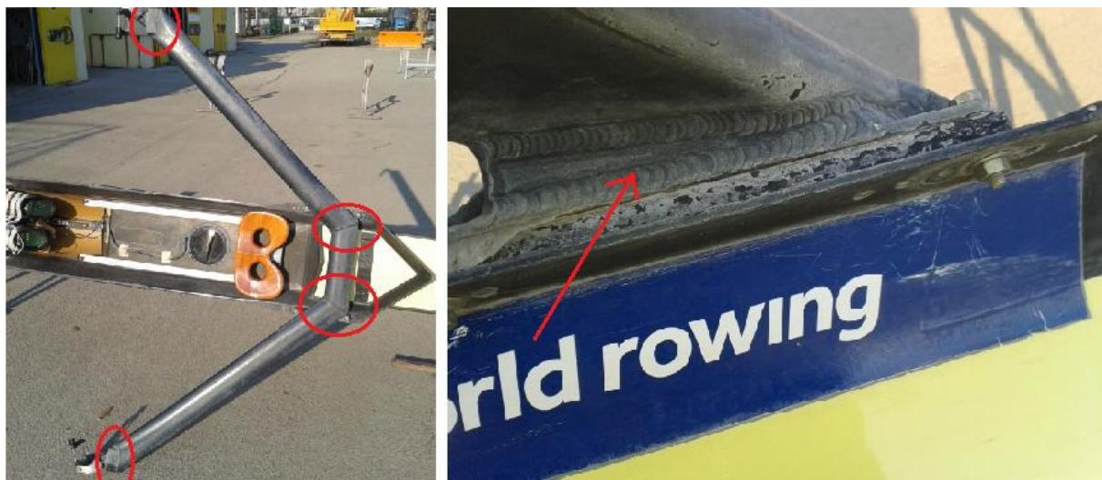
**Slika 15.** Mesta zavara na aluminijskim krilima: međusobni spojevi cijevi te spojevi cijevi i nosača za namještanje raspona ušica (lijevo); spoj cijevi i postolja (desno)
