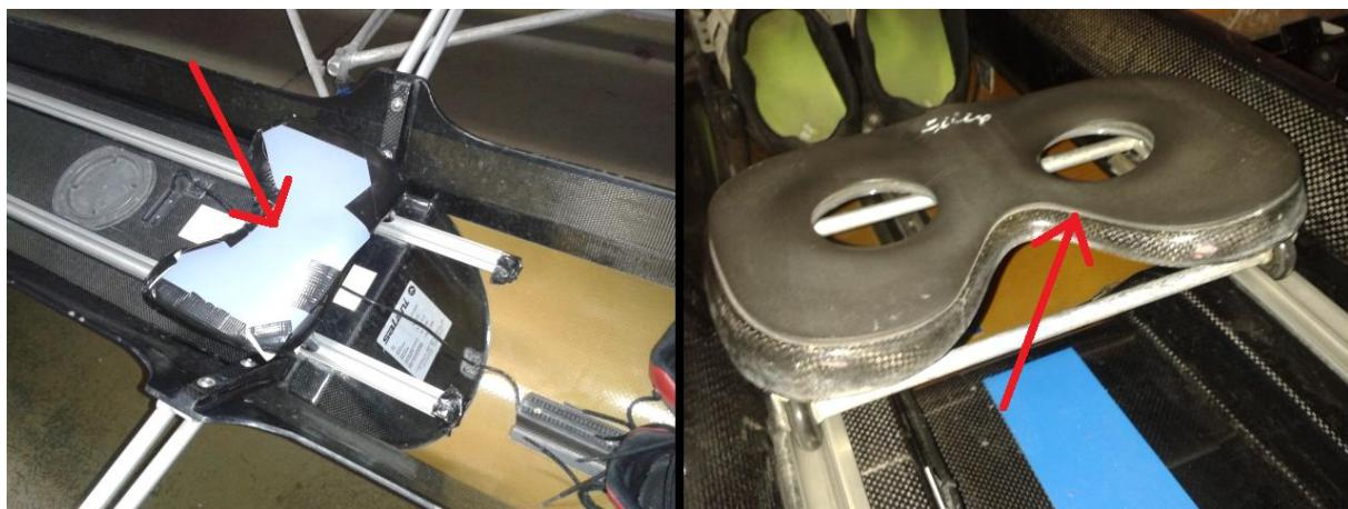
Slika 21. Pomično sjedalo s improviziranim spužvom (lijevo) i s tvorničkom spužvom (desno)
