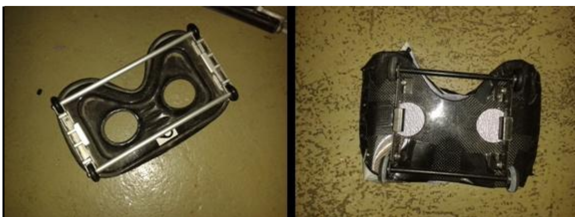
Slika 20. Pomično sjedalo od ugljičnih vlakana ljuskaste građe (lijevo) i drveno pomično sjedalo prevučeno ugljičnim vlaknima (desno)
