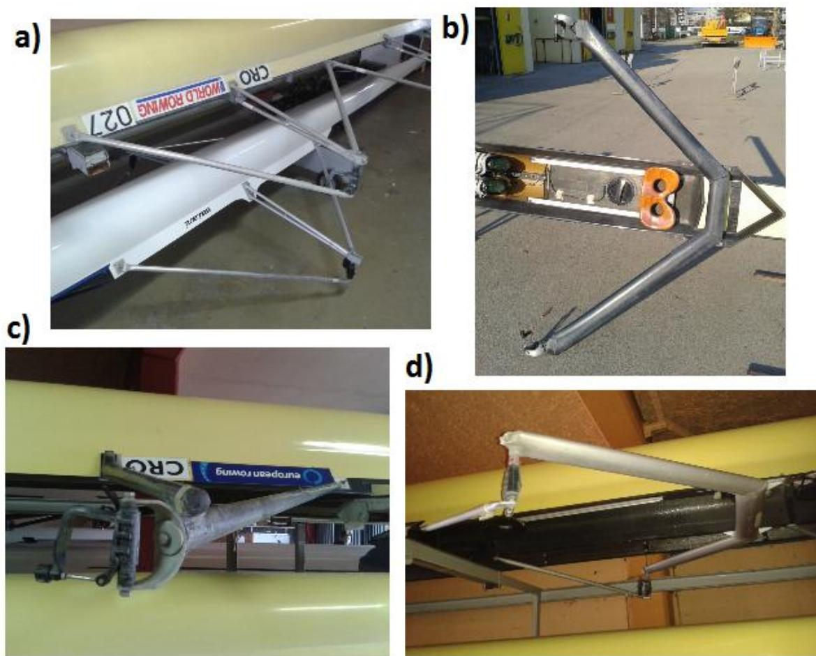
**Slika 13.** Vrste izbočnika:**a)** klasični aluminijski izbočnik, **b)** stražnje krilo,
