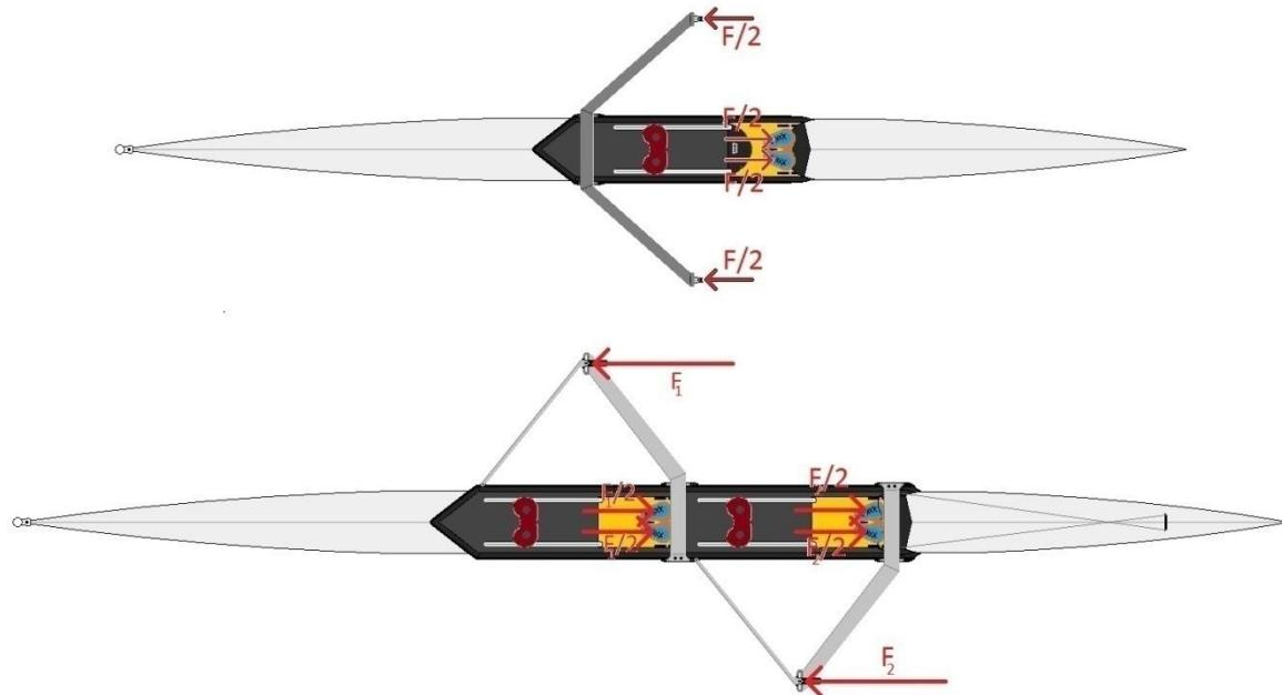
**Slika 2. Pojednostavljeni prikaz djelovanja sila veslača i vesla na čamac na pariće i na rimen-čamac u trenutku najveće sile provlaka**
