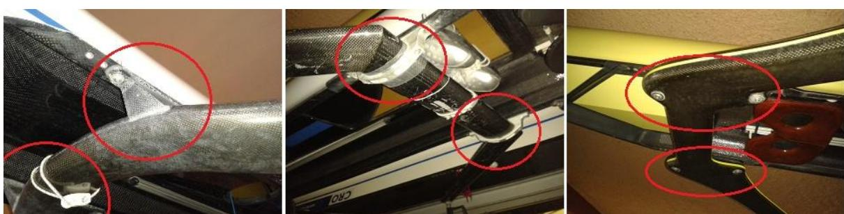
**Slika 16.** Mesta spajanja ugljičnih krila i trupa: nosači od ugljičnih vlakana (lijevo), aluminijski nosači (sredina), direktni spoj izbočnika i čamca (desno)
