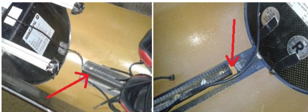
Slika 28. Postolje od ugljičnih vlakana (lijevo) i drveno postolje (desno) za zubnu letvu za podešavanje udaljenosti nogara od osovine ušice; postolje od ugljičnih vlakana je nešto lakše i mnogima atraktivnije (ovisno o boji čamca), ali se u drveno lakše fiksira zubna letva
