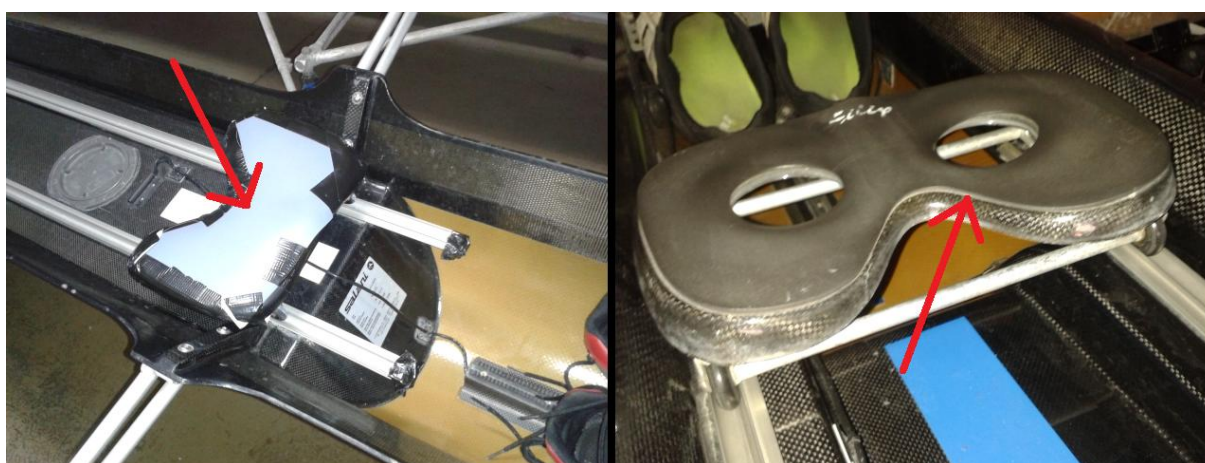
Slika 21. Pomično sjedalo s improviziranom spužvom (lijevo) i s tvorničkom spužvom (desno)
