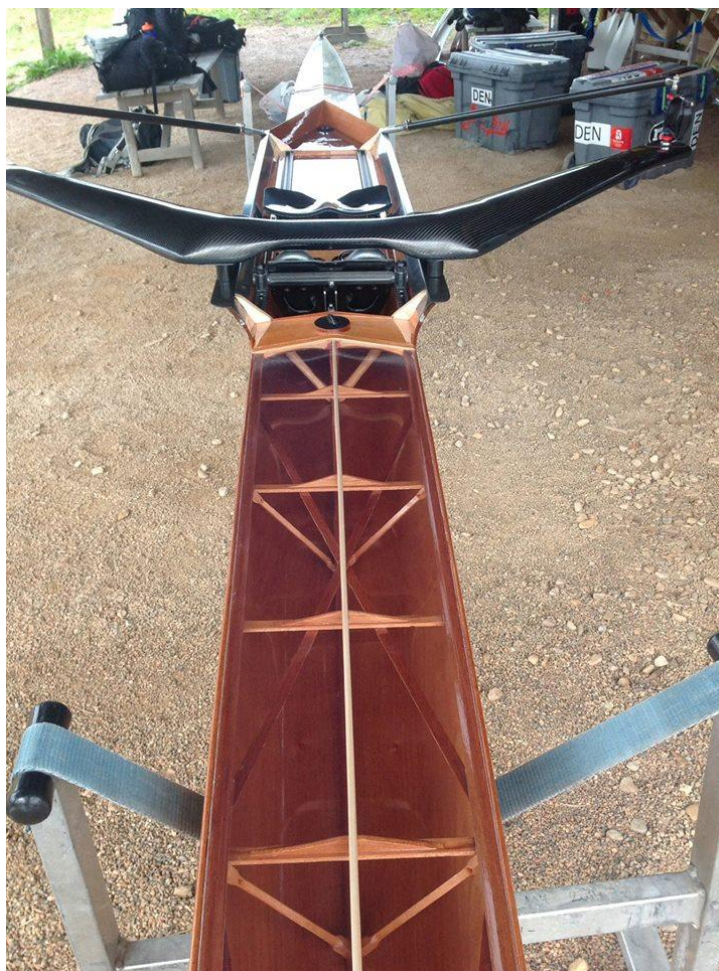
Slika30. Stämpflijev drveni samac mase 14 kg [9]
