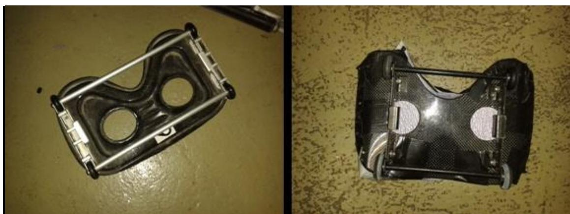
Slika 20. Pomicno sjedalo od ugljičnih vlakana ljuškaste grade (lijevo) i drveno pomicno sjedalo prevučeno ugljičnim vlknima (desno)
