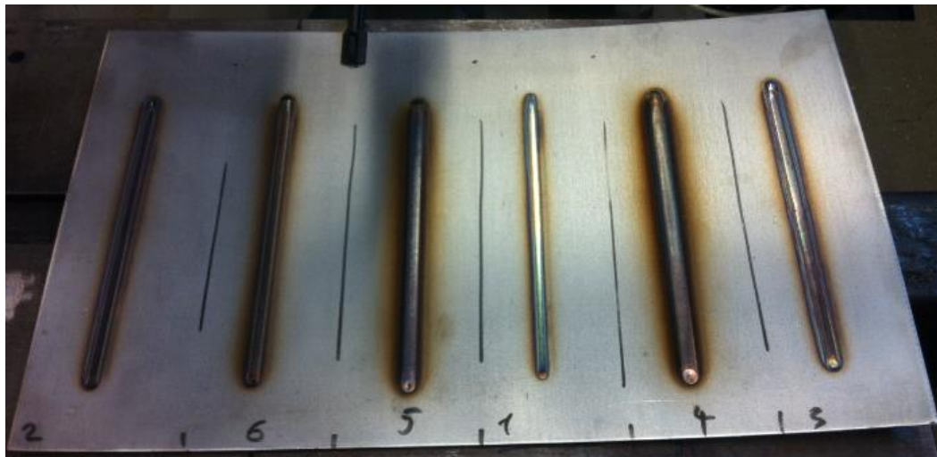
Slika 38. Ispitna ploča s navarima
