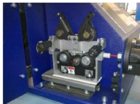
Slika 9. Unutrašnjost dodavača žice, sustav s četiri kotačića [14]
