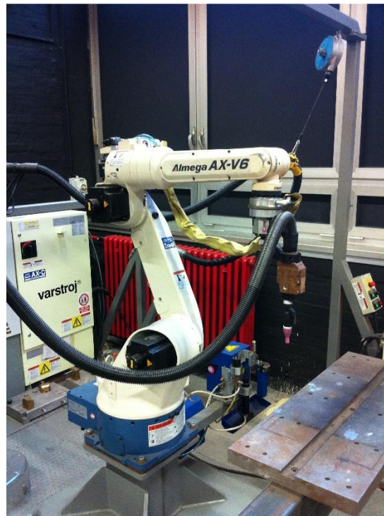
Slika 27. Robot OTC Almega AX-V6
