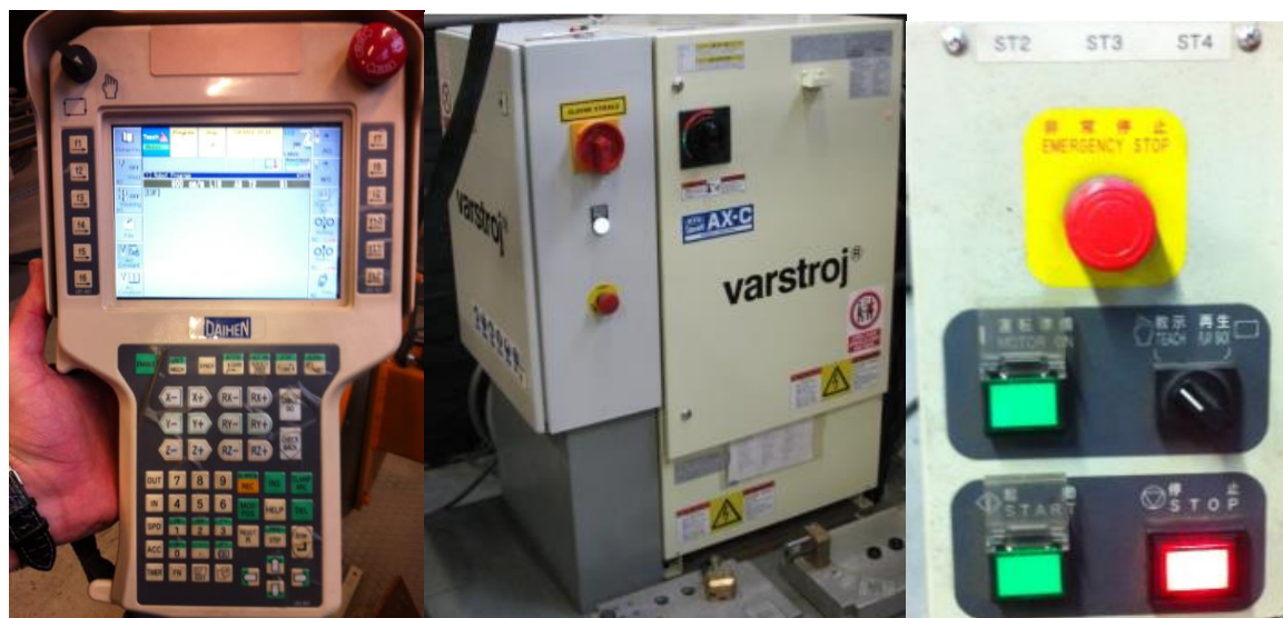
Slika 19. Privjesak za učenje (ljevo), upravljačka jedinica Almega AX-C (sredina), operatorski panel (desno)
