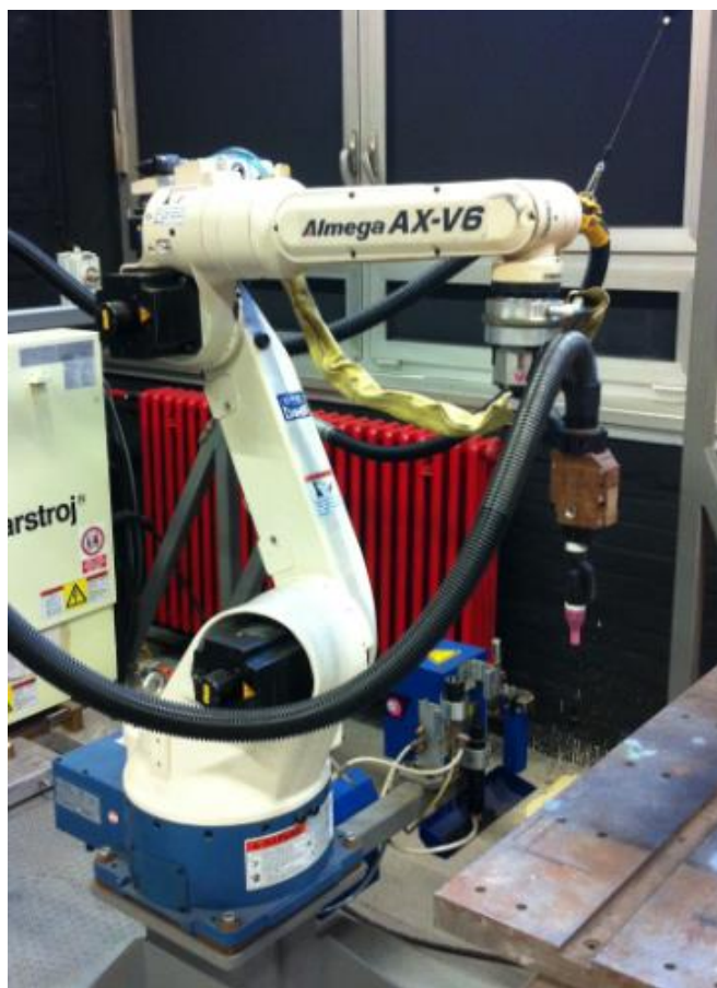
Slika 18. Robotski manipulator Almega AX-V6
