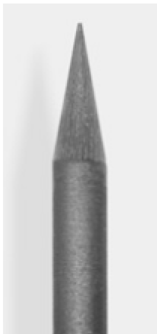
Slika 20. Izgled elektrode kod istosmjerne struje [5]
