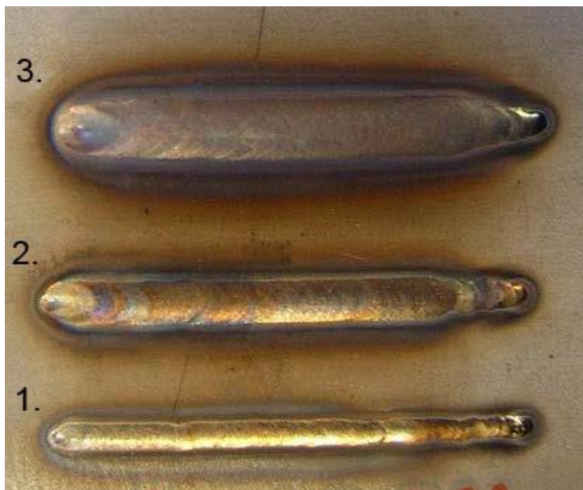
Slika 16. Uzorak 4 zaštićen argonom + 7.5% vodika [6]
