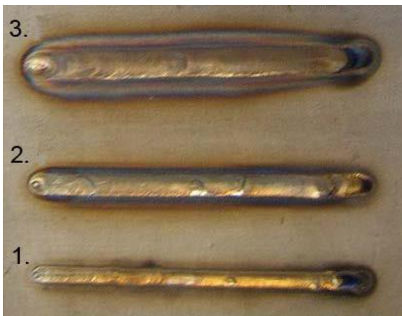
Slika 14. Uzorak 2 zaštićen argonom + 2.5% vodika [6]
