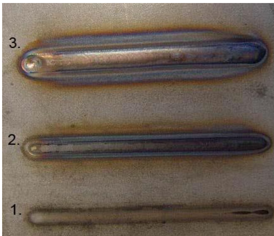
Slika 13. Uzorak 1 zaštićen čistim argonom [6]
