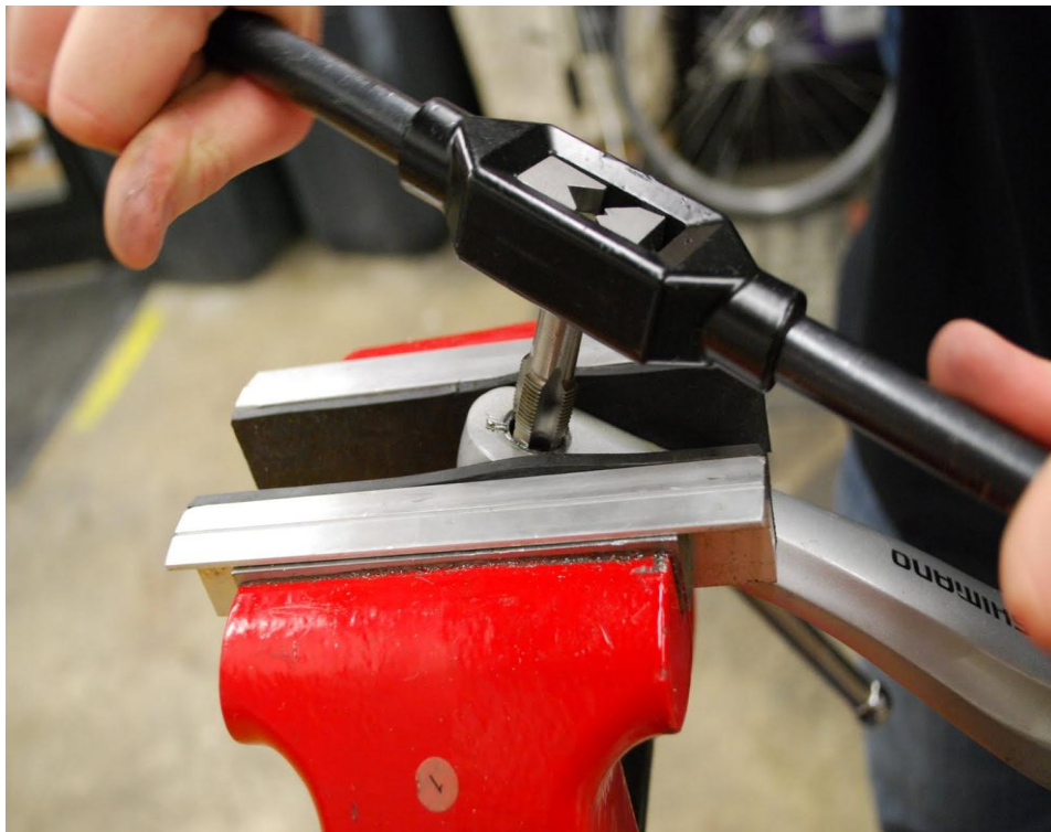
Slika 31. Ručno urezivanje navoja [16]
