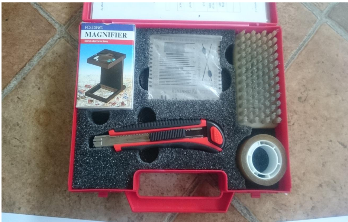
Slika 20. Oprema za cross-cut test
