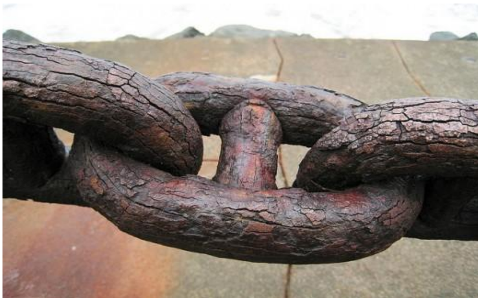
Slika 3. Opća korozija članka lanca u morskoj atmosferi [4]
