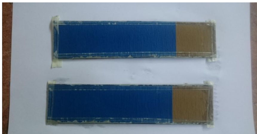
Slika 25. Ispitni uzorci nakon ispitivanja u vlažnoj komori
