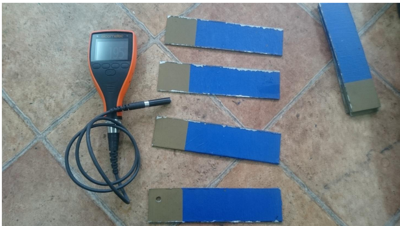
Slika 19. Uređaj Elcometer 456 za ispitivanje debljine suhog filma premaza i ispitni uzorci
