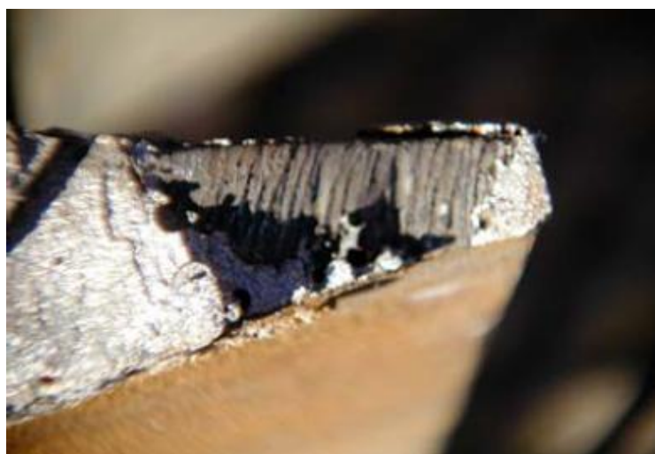
Slika 38 Nedovoljno taljenje u nožici tračnice uzrokovano pomicanjem kalupa [19]
