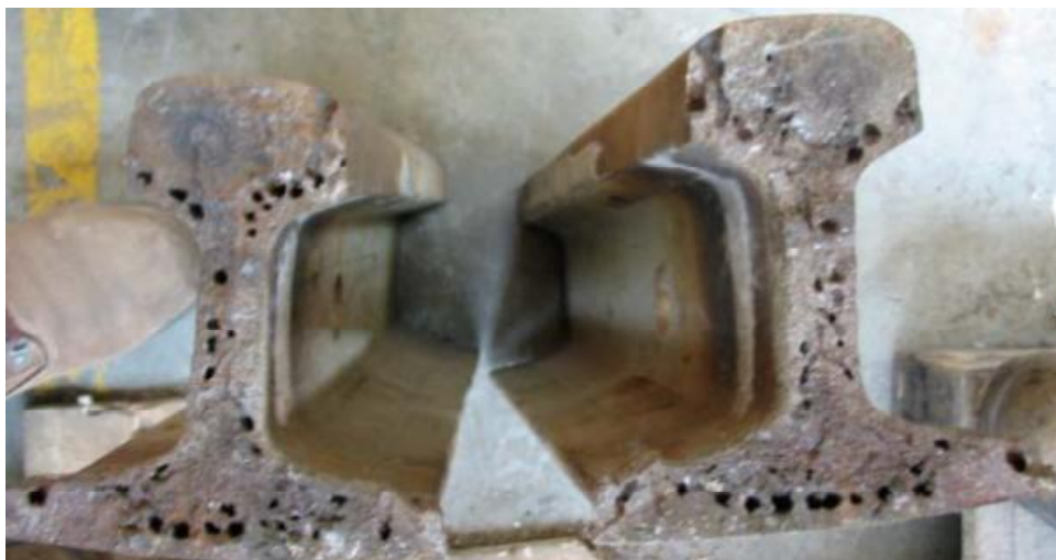
Slika 40 Porozitet u zavaru [19]
