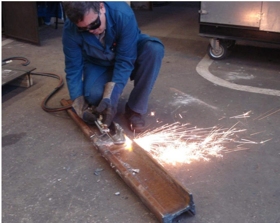
Slika 42 Plinsko rezanje tračnice
