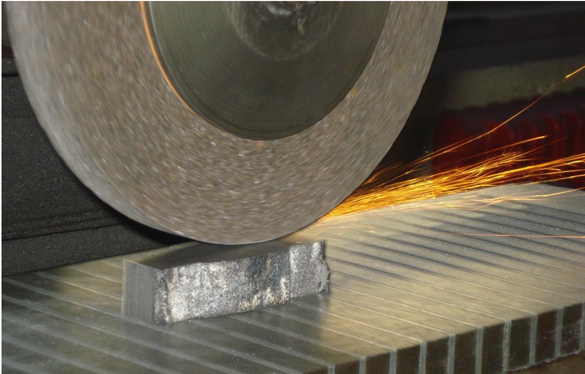
Slika 44 Brušenje uzorka brusilicom
