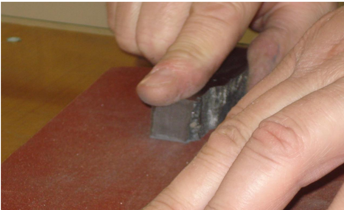
Slika 45 Ručno poliranje uzorka brusnim papirom
