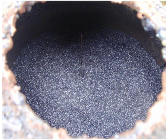
Slika 27 Prskalica i termitna masa u tiglu [16]
