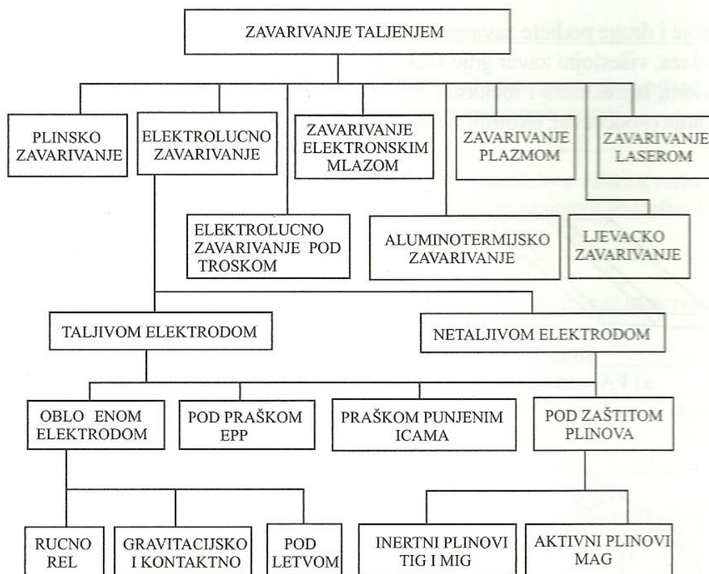
Slika 1 Podjela postupaka zavarivanja taljenjem [3]
