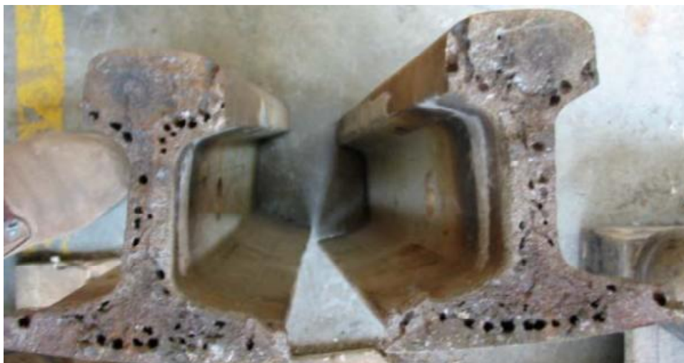
Slika 40 Porozitet u zavaru [19]
