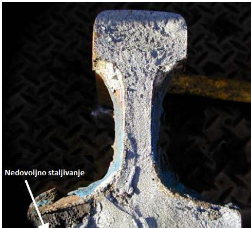
Slika 37 Nedovoljno staljivanje u nožici tračnice [19]
