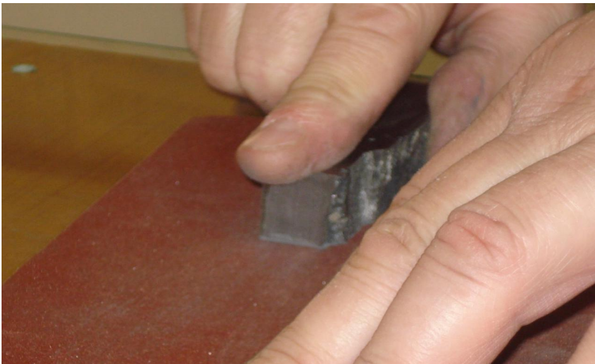
Slika 45 Ručno poliranje uzorka brusnim papirom
