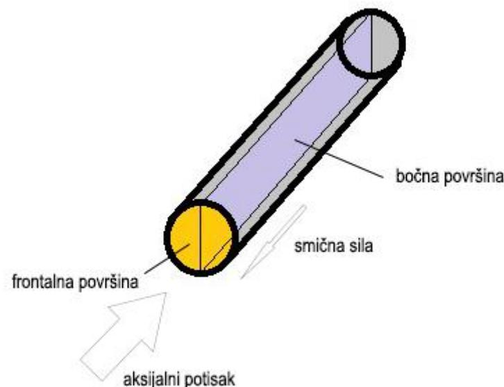
Slika 3.1. Cilindrični čep
