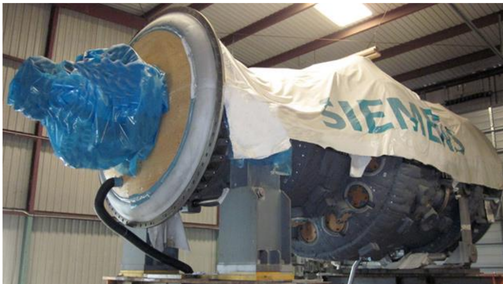
Slika 15. Plinska turbina SGT6-3000E proizvođača Siemens [7]
