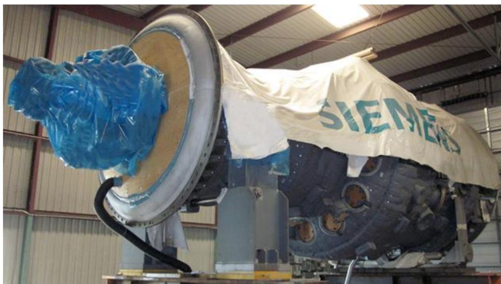
Slika 15. Plinska turbina SGT6-3000E proizvođača Siemens [7]
