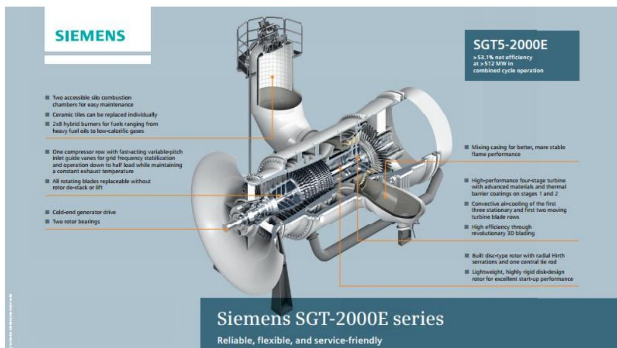
Slika 16. Plinska turbina SGT5-2000E proizvođača Siemens [7]
