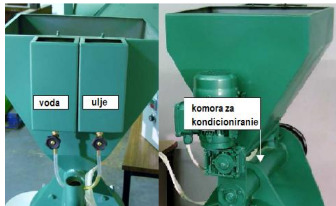
Slika 16. Sustav za prpremu sirovine [12]
