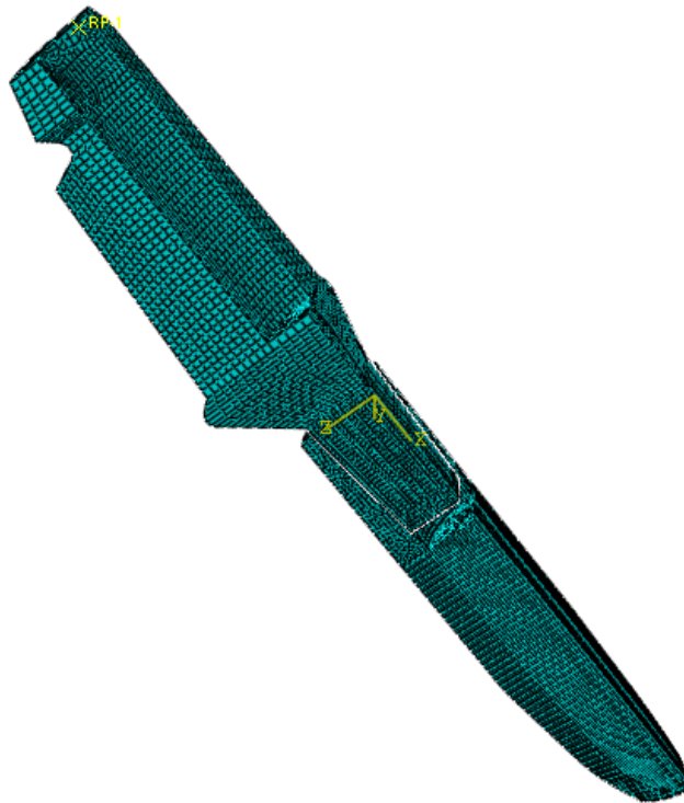
Slika 20. Model sa mrežom konačnih elemenata (42824 konačnih elemenata)
