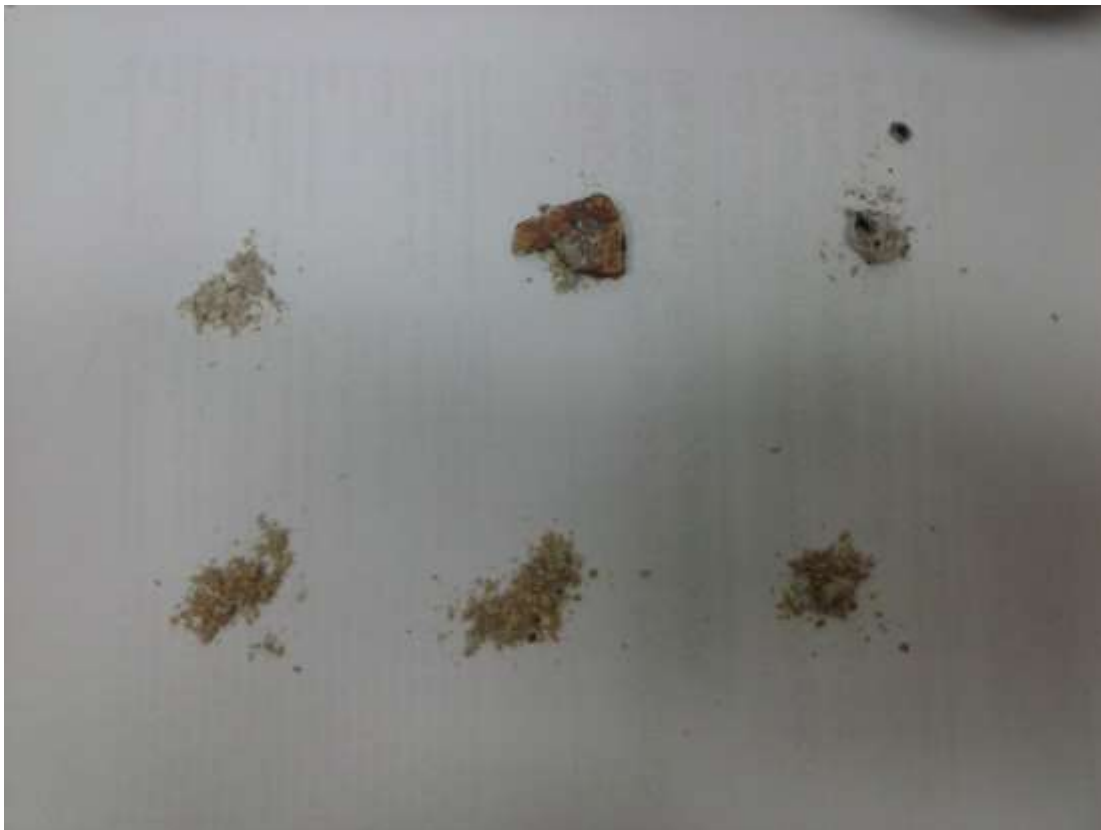
Slika 3.5. Uzorci pepela nakon izgaranja. 3 u dostavnom i 3 u sušenom stanju
