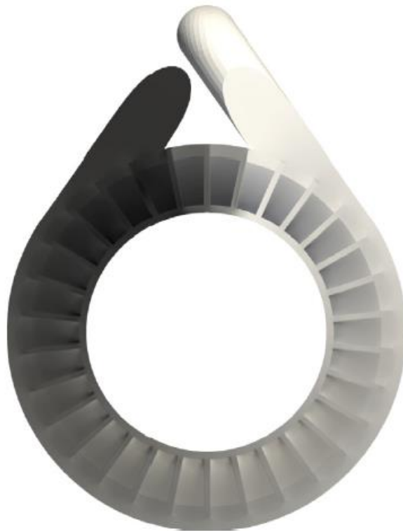
Slika 1.8 Ustrujavanje fluida u kanal i porast tangencijalnog tlaka kroz obodnu pumpu
