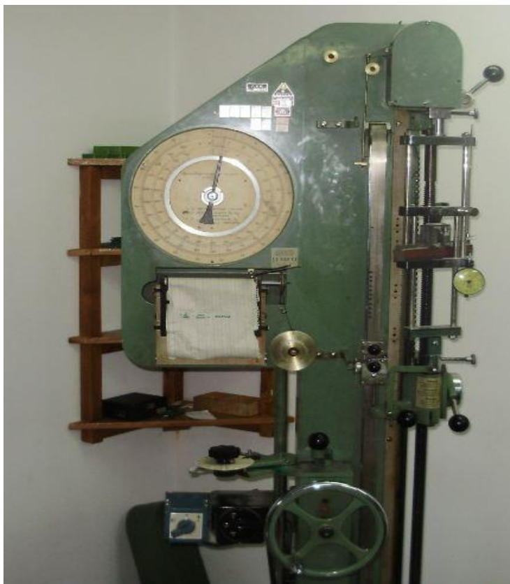
Slika 8. Ispitivanje savojne čvrstoće na univerzalnoj kidalici
