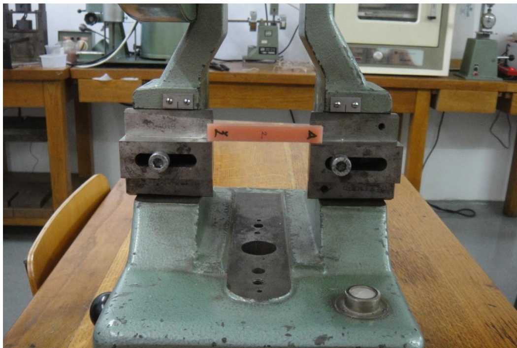
Slika 23: Epruveta u čeljusti Charpy-evog bata
