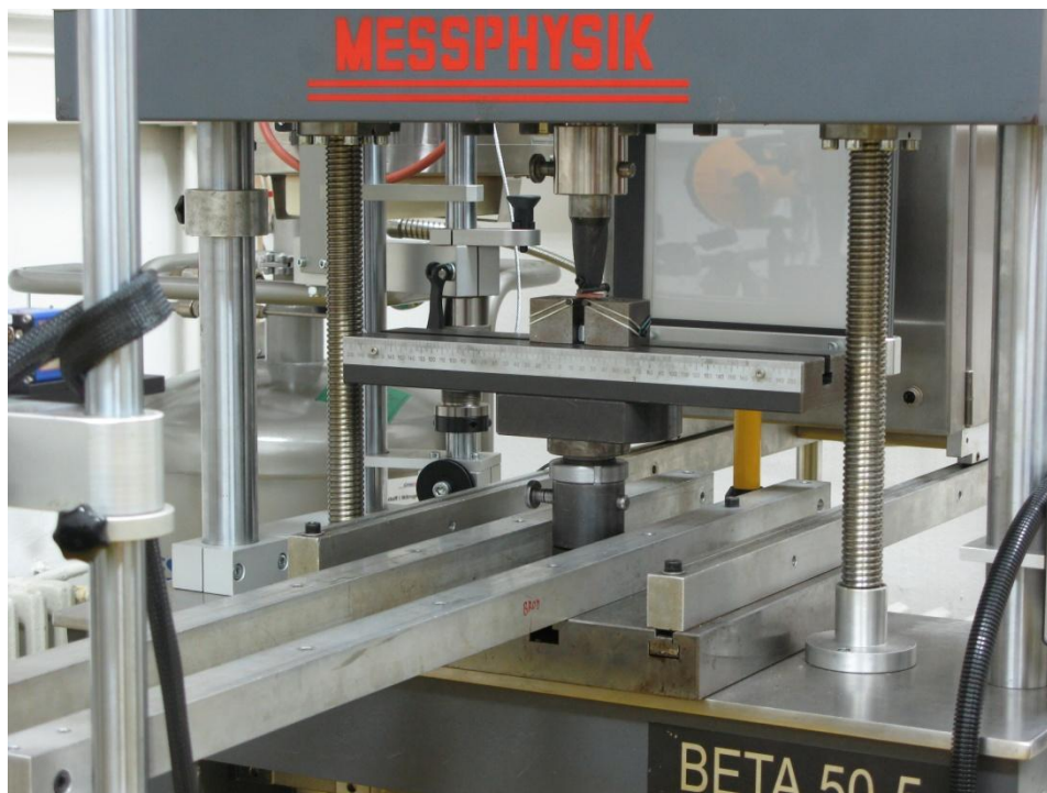
Slika 27: Stroj za ispitivanje savijanja u tri točke
