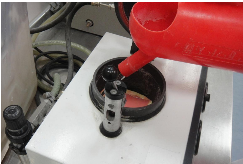
Slika 16: Ulijevanje vode u Ivomat za polimerizaciju AO 1
