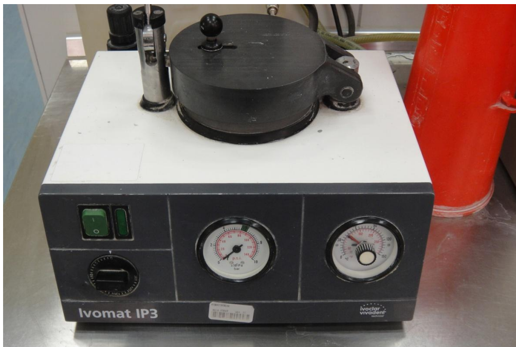
Slika 3: Ivomat – uređaj za tlačno – toplinsku polimerizaciju
