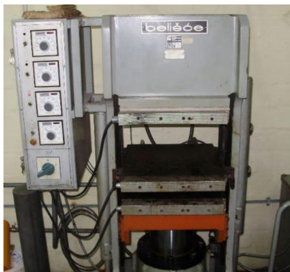
Slika 5.1. Etažna preša tipa PHPVEH 100, Belišće
