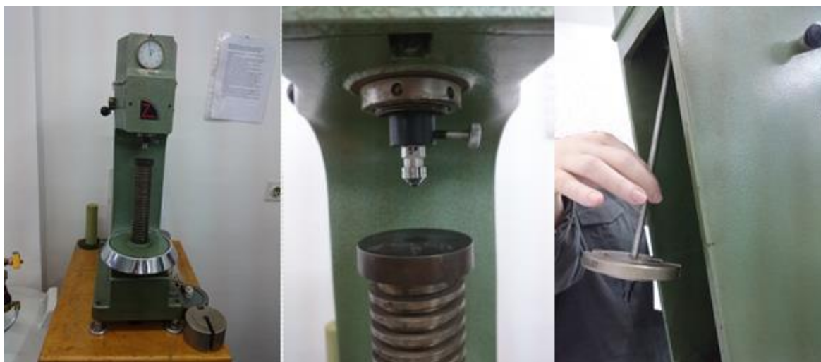
Slika 5.16. a) Tvrdomjer; b) kuglica; c) čelična šipka za utege
