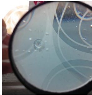
Slika 5.9. Samoobnovljeno oštećenje nakon probijanja metkom
