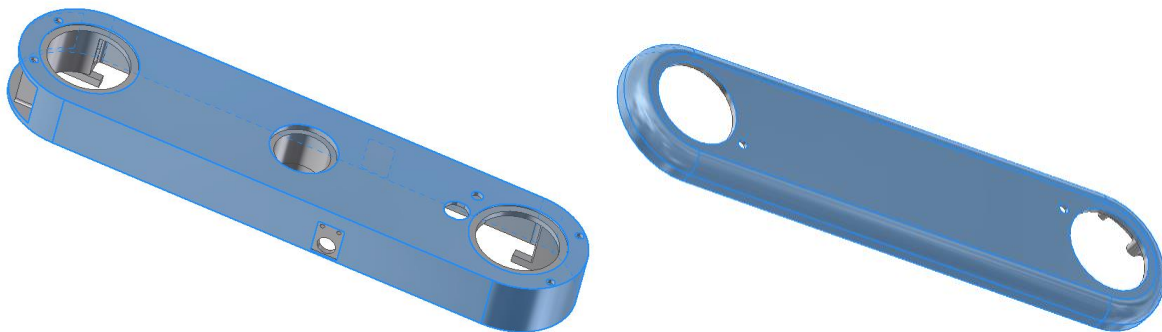
Slika 34 Uz objašnjenje stanjivanja stijenke kućišta
