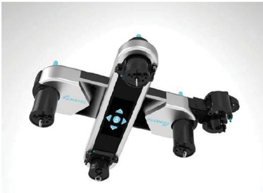
Slika 2 Uređaj za ispitivanje cijevi parogeneratora
