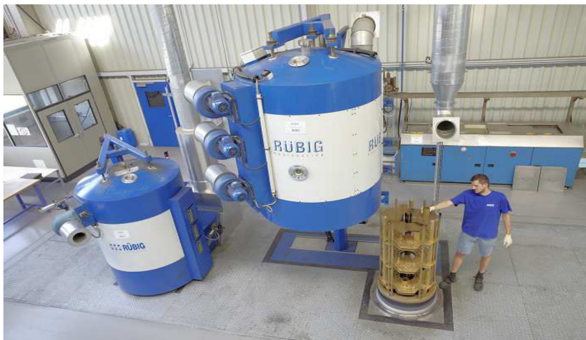
Slika 1. PACVD sustav tvrtke RÜBIG iz Austrije [3]
