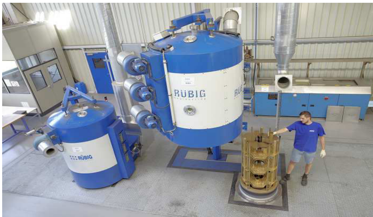
Slika 1. PACVD sustav tvrtke RÜBIG iz Austrije [3]
