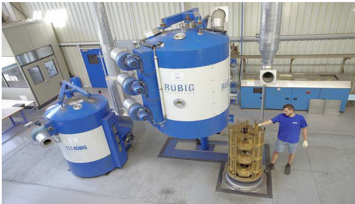
Slika 1. PACVD sustav tvrtke RÜBIG iz Austrije [3]
