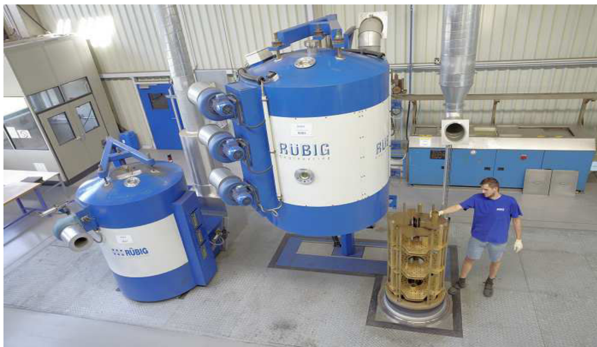
Slika 1. PACVD sustav tvrtke RÜBIG iz Austrije [3]
