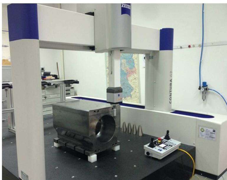
Slika 19. ZEISS Contura G2 koordinatni mjerni stroj
