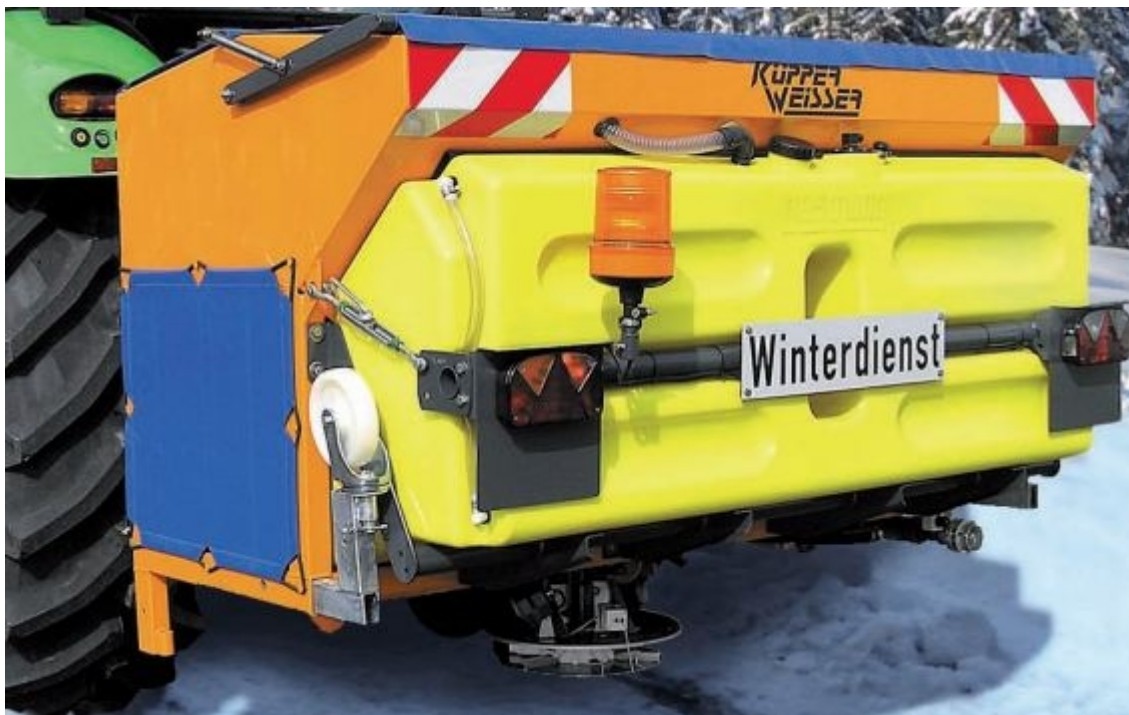
Slika 12. Küpper-Weisser – IMS P posipač
