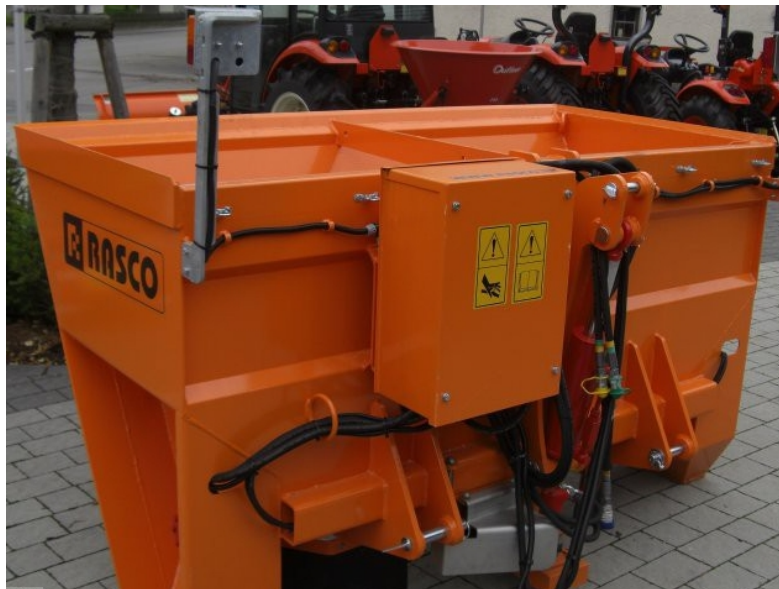
Slika 13. RASCO TRP- posipač, pogled straga
