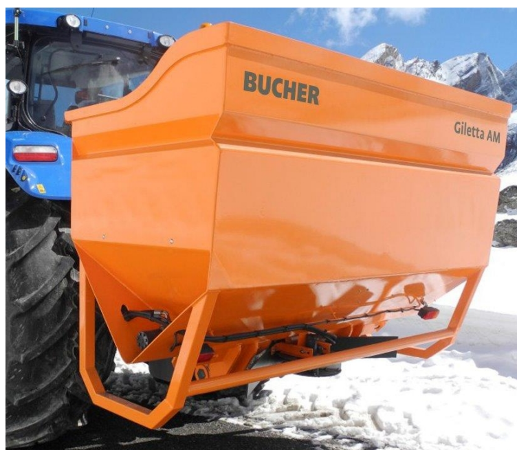
Slika 8. Bucher- Giletta AM posipač
