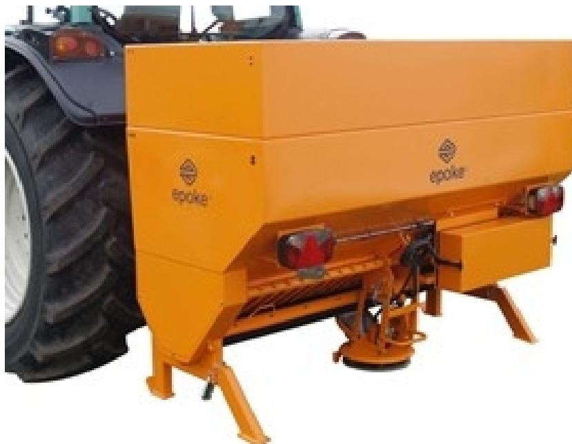
Slika 11. Epoke -TP posipač
