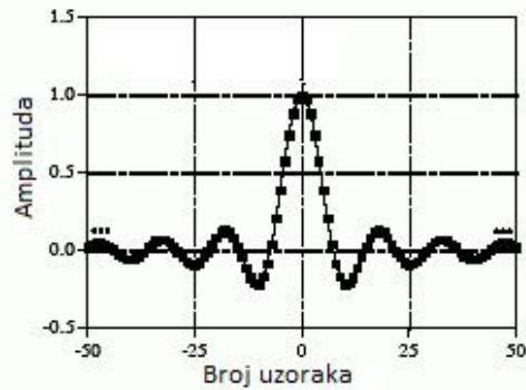
Slika 6.2. Impulsni odziv idealnog niskopropusnog filtera
