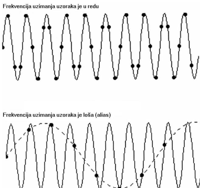
Slika 2.4. Ovisnost izgleda snimljenog signala o  $f_{sr}$
