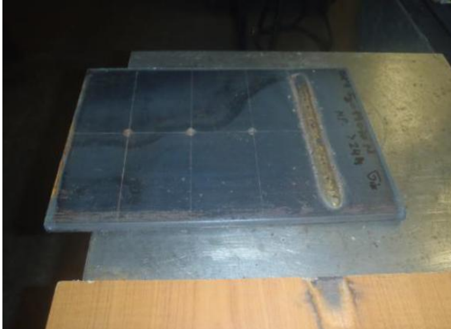
Slika 19 Prikaz navara na Implant pločama [10].
