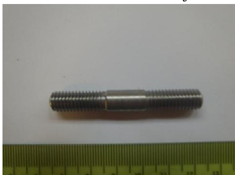
Slika 18 Implant uzorak s obostranim navojem [10].
