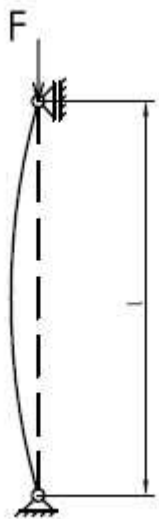
Slika 39. Model izvijanja vretena
