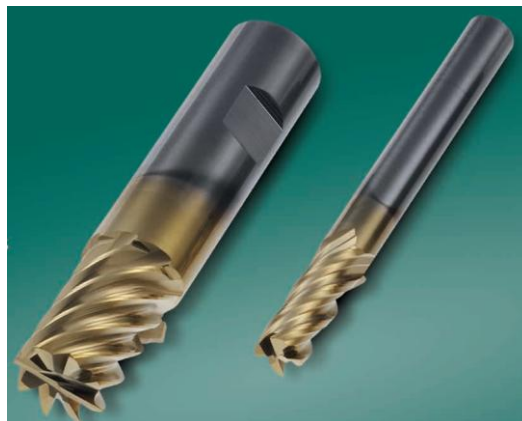
Slika 22. Prikaz TiN prevlake [12]
