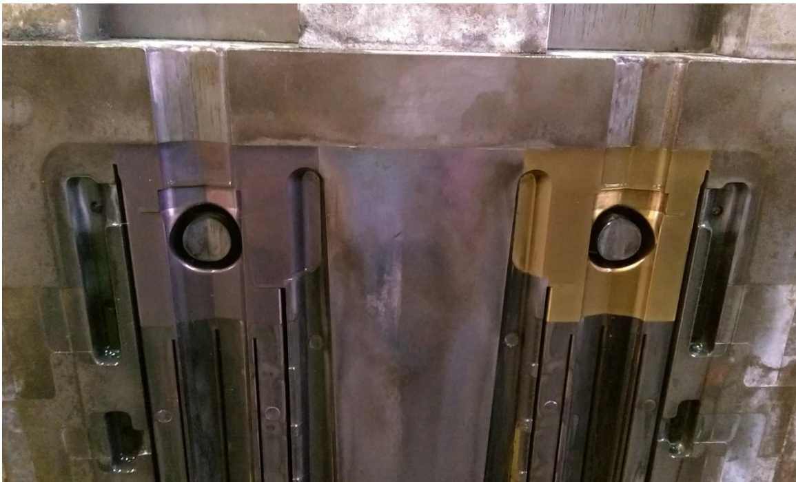
Slika 26. Segmenti ugrađeni u kalup
