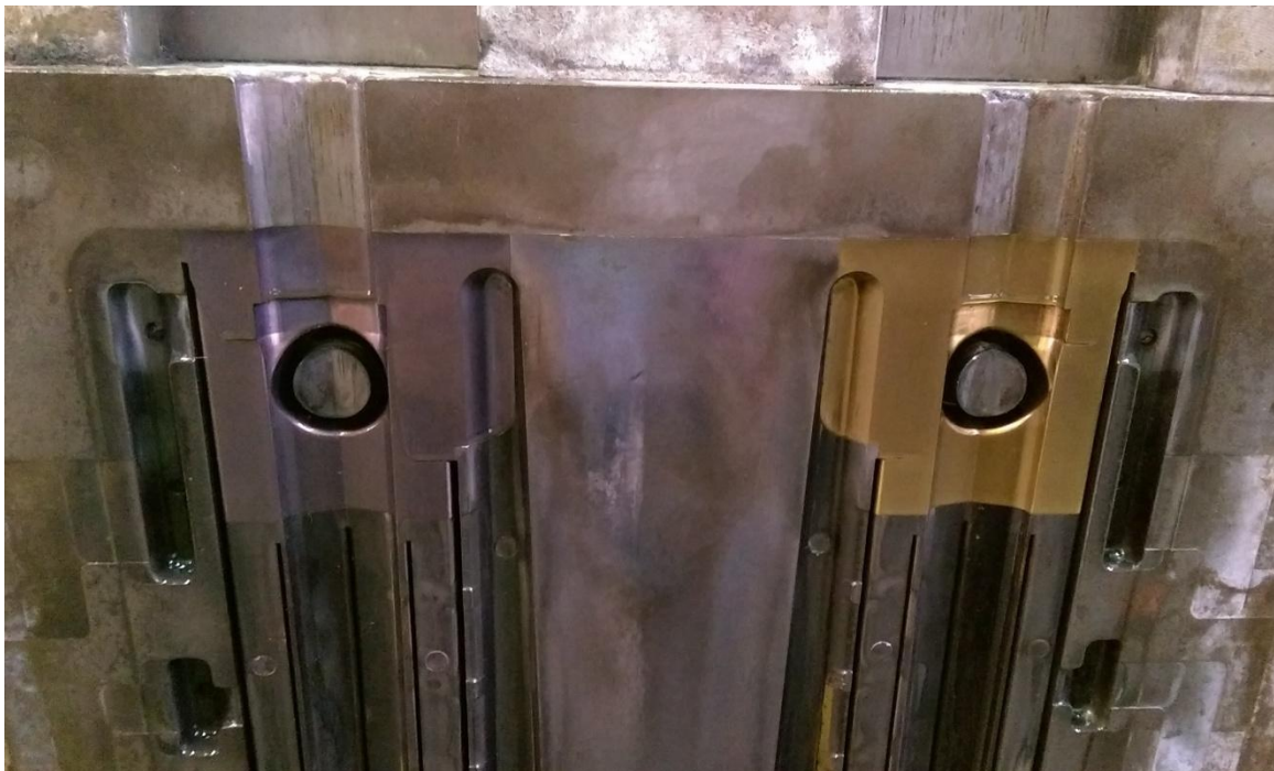
Slika 26. Segmenti ugrađeni u kalup
