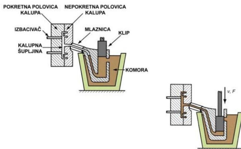
Slika 4. Tlačni lijev s topom komorom [4]
