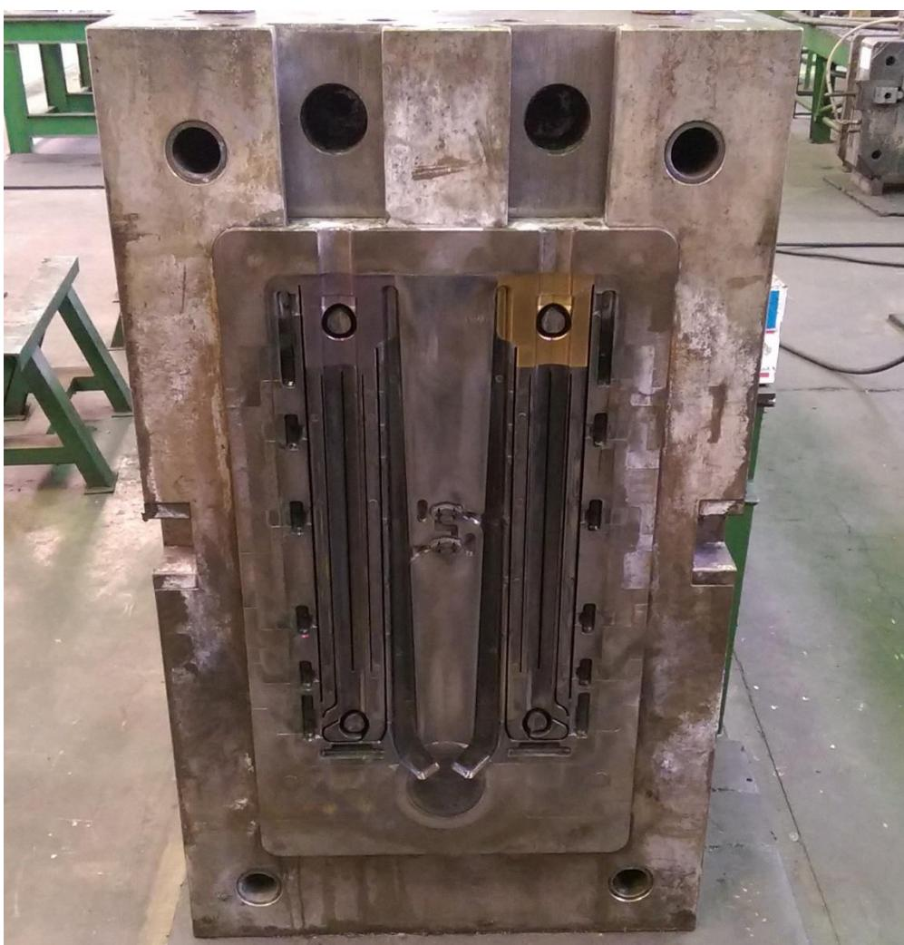
Slika 27. Kalup za tlačni lijev radijatorskih članaka
