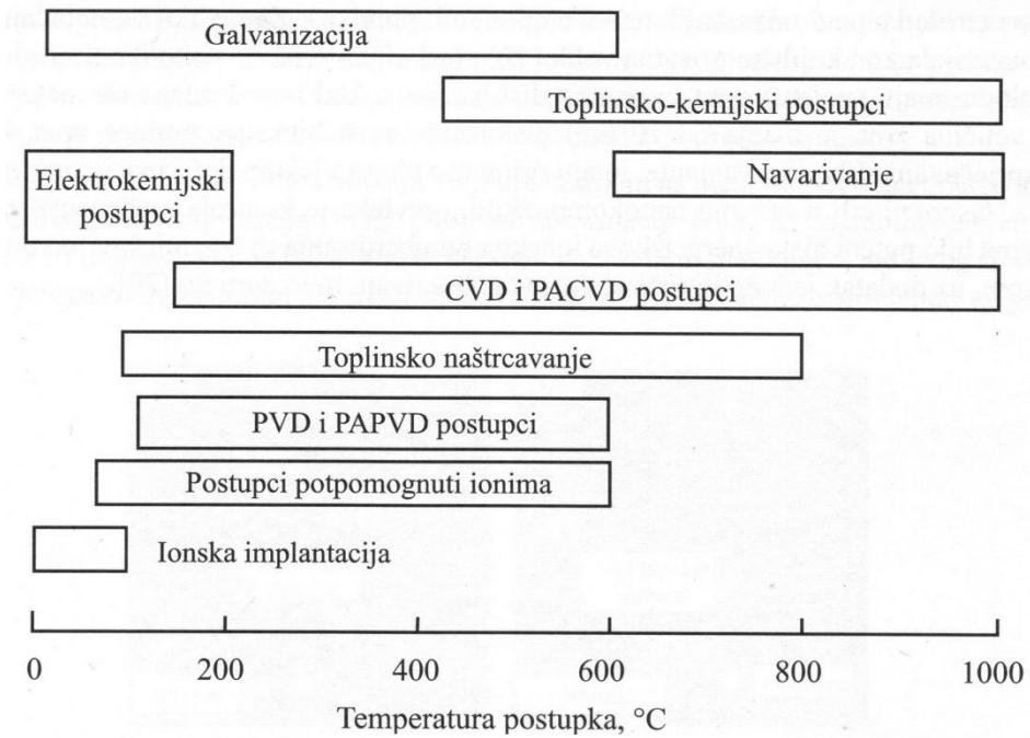
Slika 14. Debljine slojeva i temperature postupaka [8]
