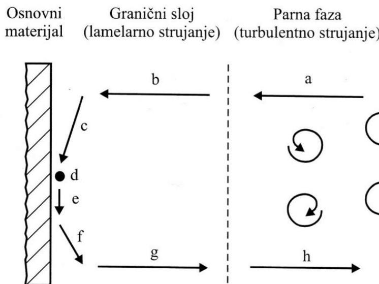
Slika 17. Shematski prikaz pojedinačnih faza CVD procesa [8]
