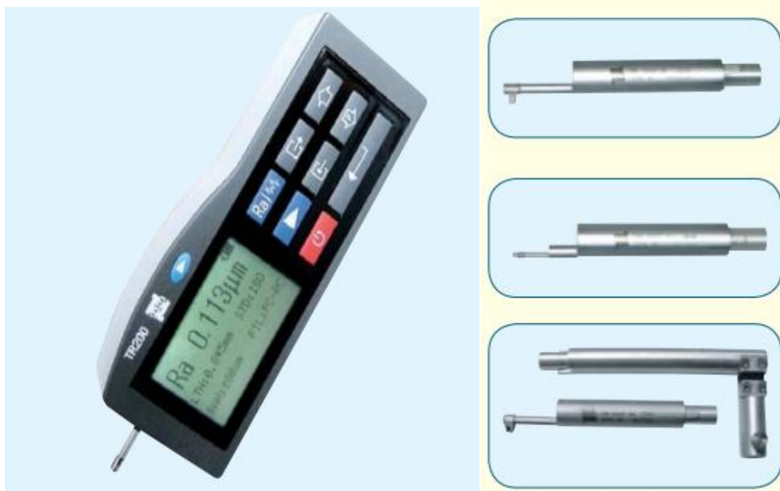
Slika17. Prijenosni uređaj i karakteristične vrste ticala
