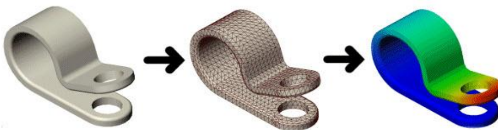
Slika 7. Prikaz diskretizacije modela [6]
