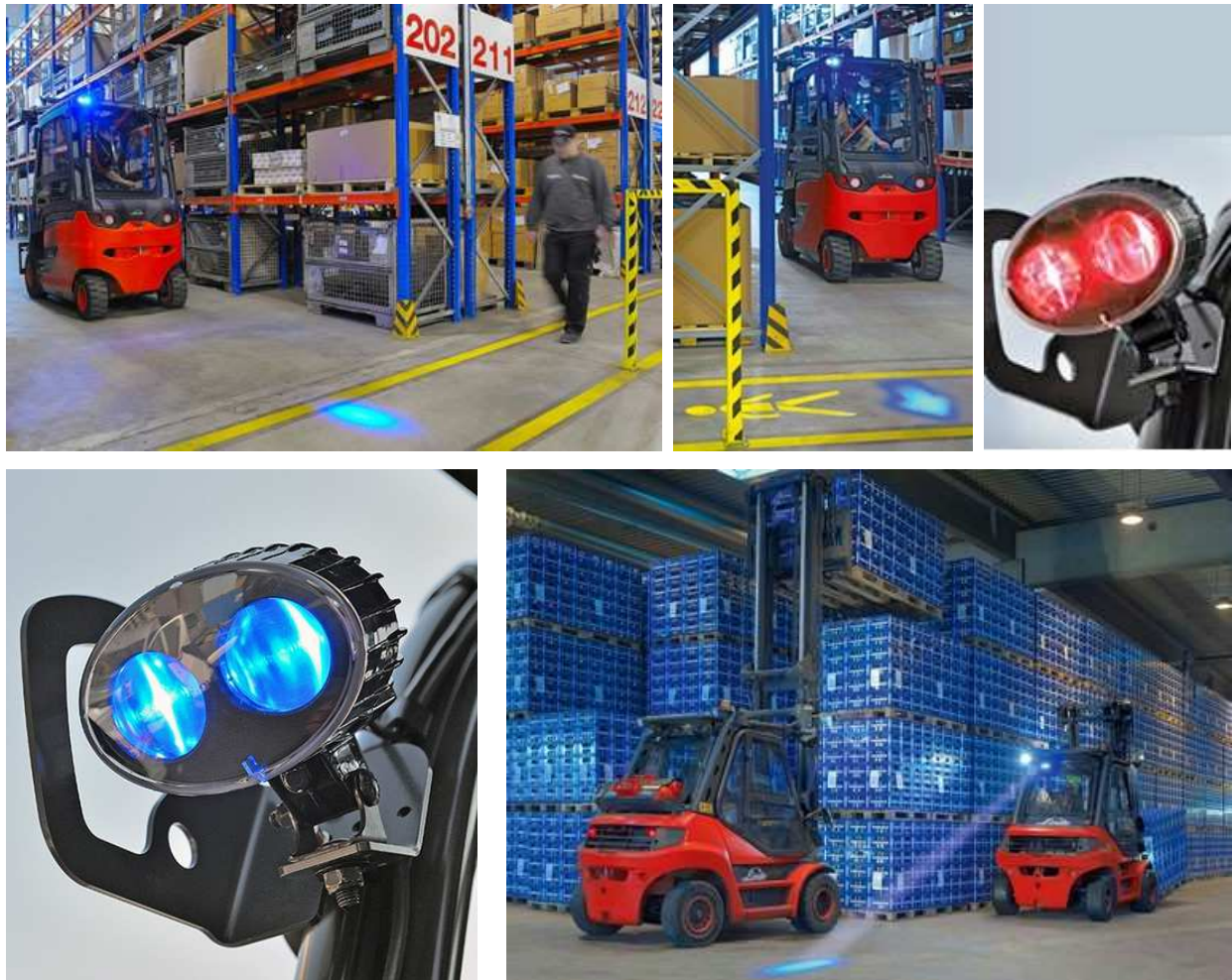
Slika 40. Linde "BlueSpot" sustav upozorenja
