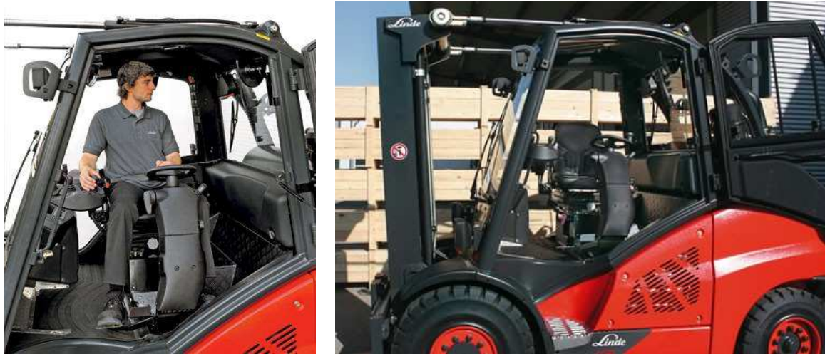
Slika 27. Viličar sa zakretnim sjedalom za 90°, koje se zakreće zajedno s volanom i upravljačkim kontrolama tereta [41]
