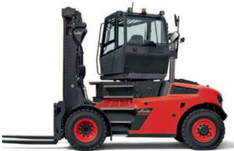
Slika 34. Viličar sa rotirajućom kabinom, Linde H120 [39]
