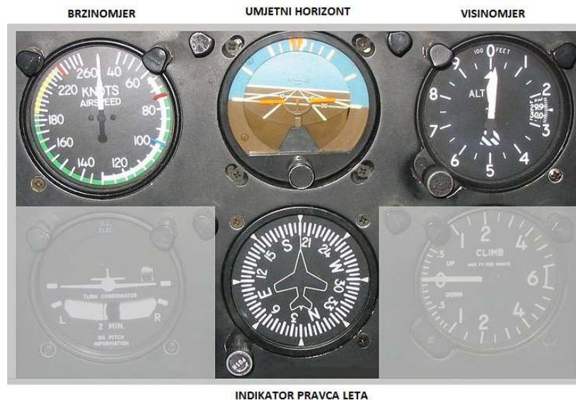
Slika 4. T-raspored zrakoplovnih instrumenata s njihovim nazivima [7]
