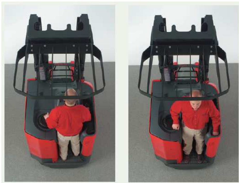
Slika 38. Raymondov viličar s mogućnošću usmjerenja vozača u smjeru vožnje
