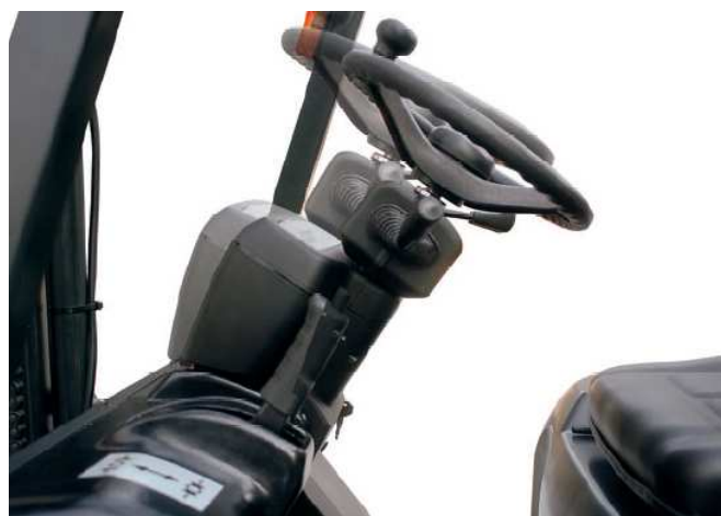
Slika 28. Podešavanje volana naprijed-nazad [61]
