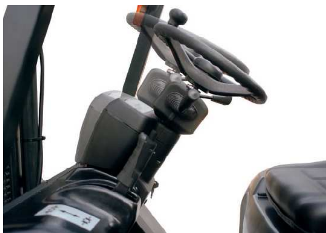
Slika 28. Podešavanje volana naprijed-nazad [61]
