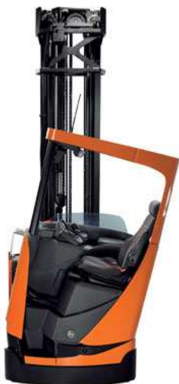
Slika 39. Toyota BT Reflex visokoregalni viličar
