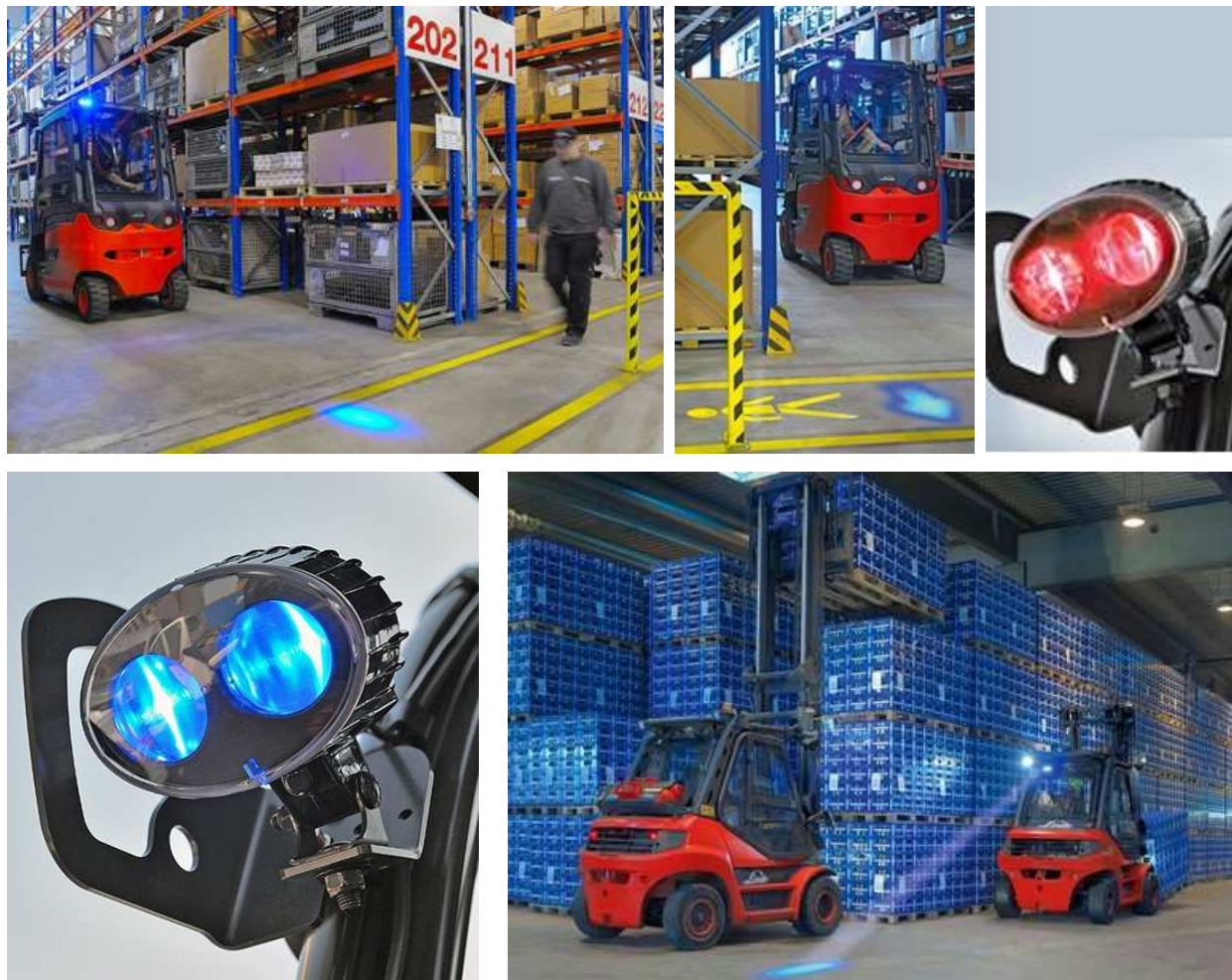
Slika 40. Linde "BlueSpot" sustav upozorenja
