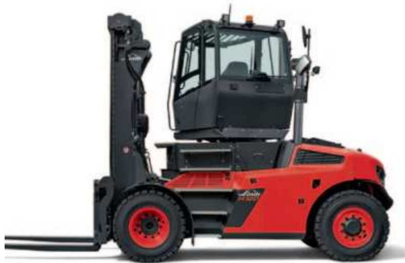
Slika 34. Viličar sa rotirajućom kabinom, Linde H120 [39]
