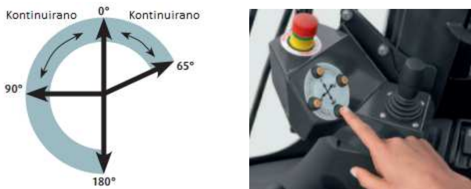
Slika 35. Kutevi zakretanja i način upravljanja [39]
