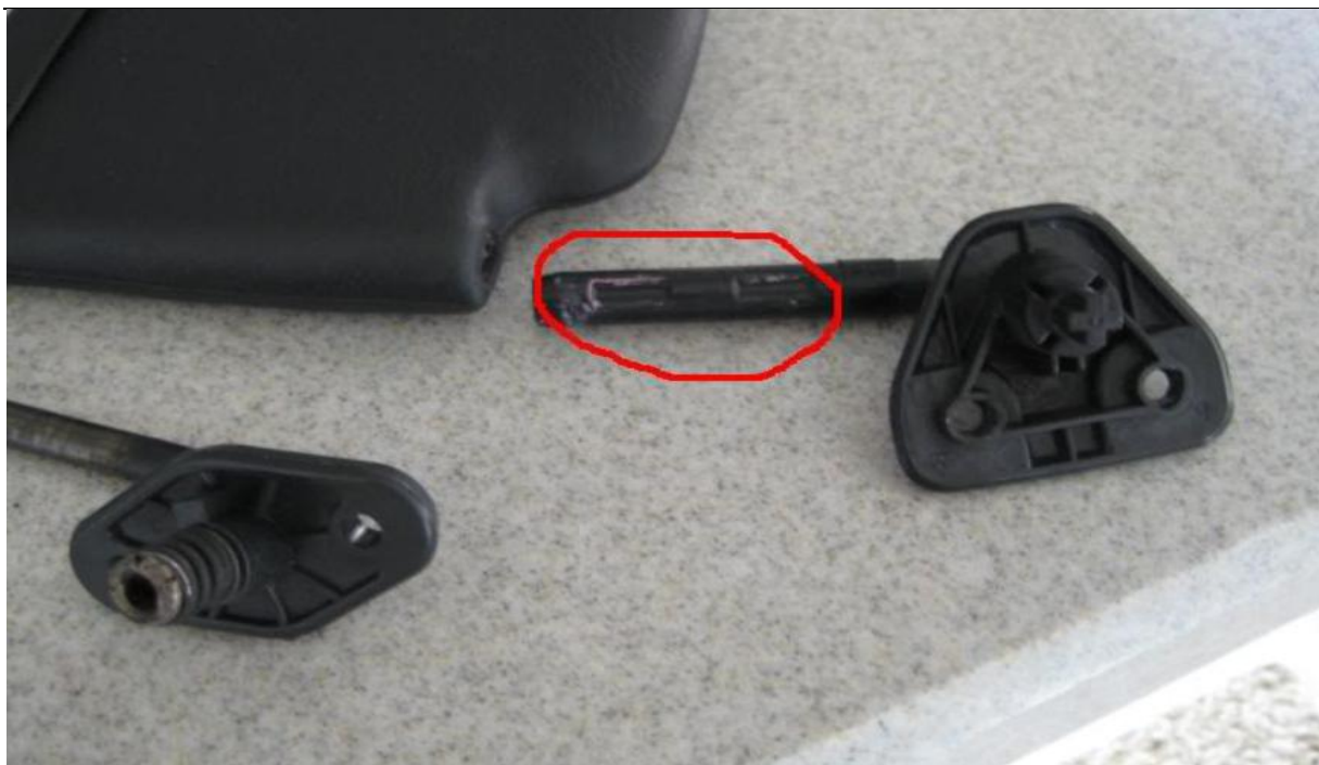
Slika 7. Problem ležištenja osovinice
