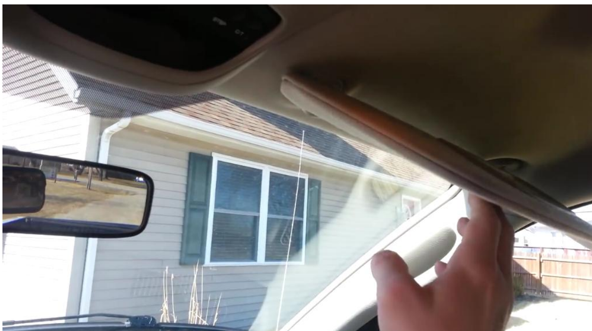
Slika 6. Istrošeno / labavo sjenilo
