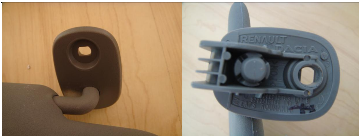
Slika 5. Kopča automobilskog sjenila, AD-Plastik, uzorak
