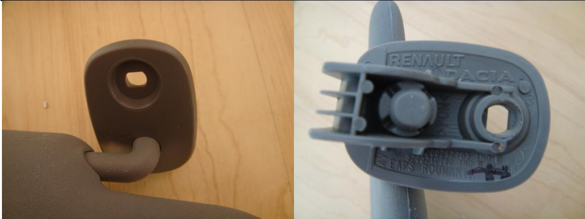
Slika 5. Kopča automobilskog sjenila, AD-Plastik, uzorak
