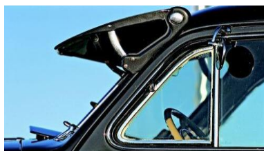
Slika 2. Podesivo vanjsko sjenilo, Buick Special iz 1940.godine
