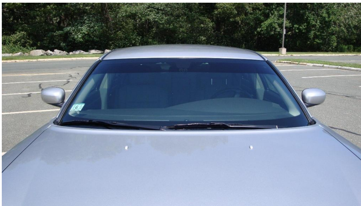
Slika 22. Zatamnjanje gornjeg dijela vjetrobranskog stakla
