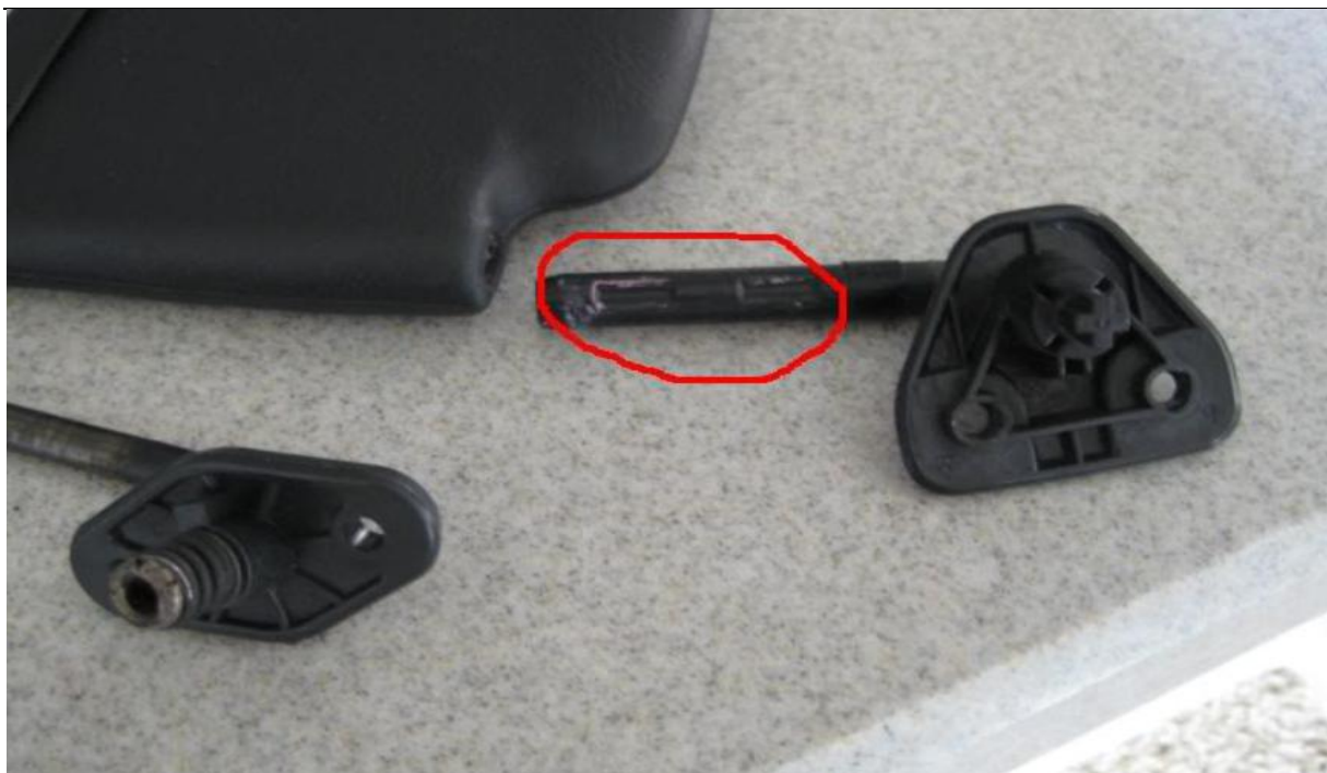
Slika 7. Problem ležištenja osovinice
