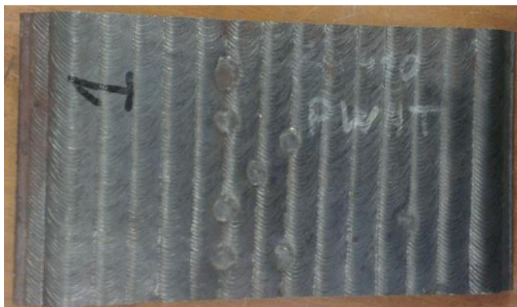
Slika 22 Ploča navarena AISI 410 materijalom
