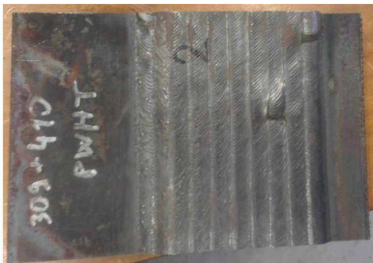
Slika 23 Ploča navarena materijalima AISI 309 i AISI 410
