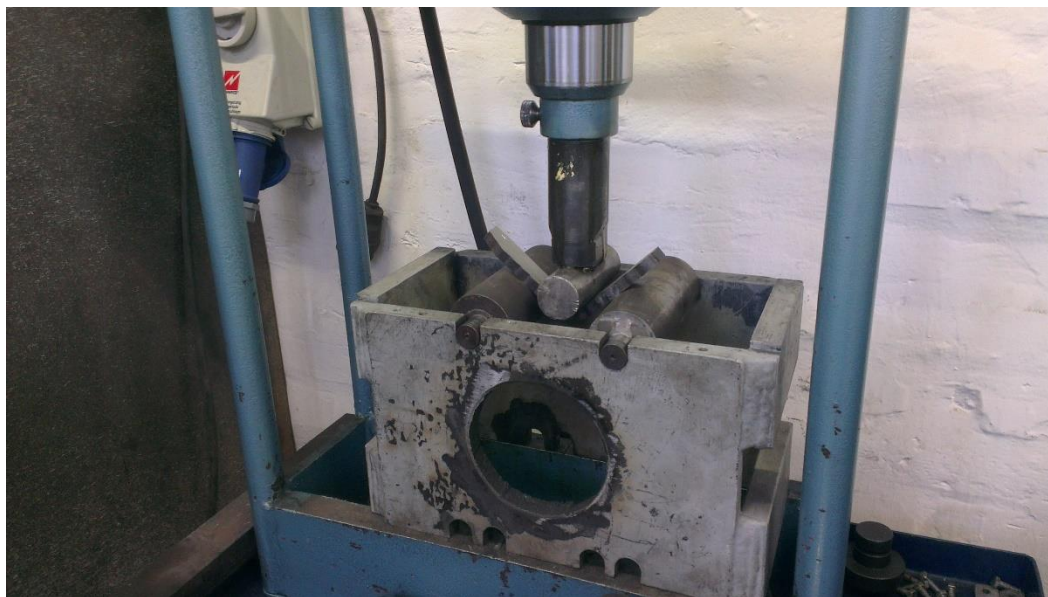
Slika 27 Provođenje ispitivanja na bočno savijanje
