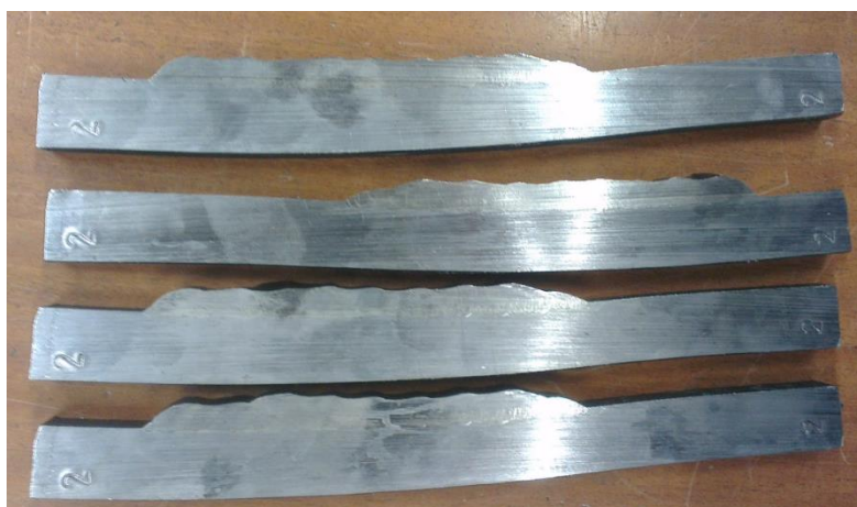
Slika 26 Epruvete izrezane iz ploča navarenih AISI 410 materijalom
