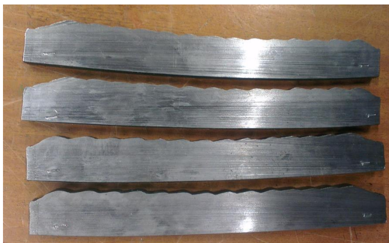
Slika 25 Epruvete izrezane iz ploča navarenih AISI 410 materijalom
