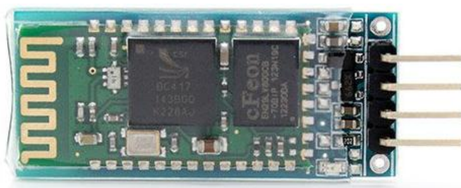
Slika 22. Bluetooth slave modul - HC-06
