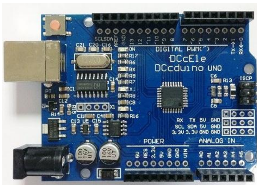
Slika 21. Mikrokontroler - DCcduino uno
