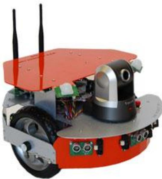
**Slika 1. Primjer mobilnog robota - X80SV**
