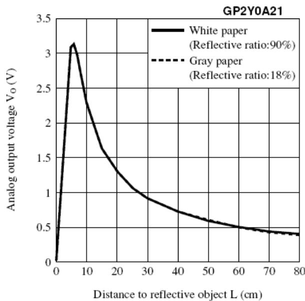
Slika 19. Karakteristika Sharp 2Y0A21 infracrvenog daljinomjera [8]
