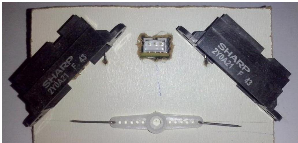
Slika 17. Tlocrt rotacijskog daljinomjera
