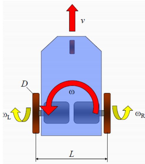
**Slika 4. Diferencijalna struktura robota [2]**
