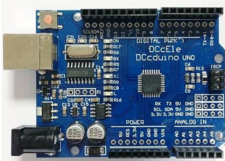
Slika 21. Mikrokontroler - DCcduino uno
