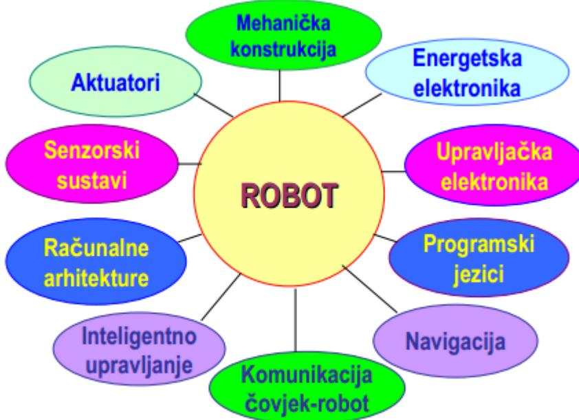
Slika 2. Roboti - mehatronički sustavi [3]
